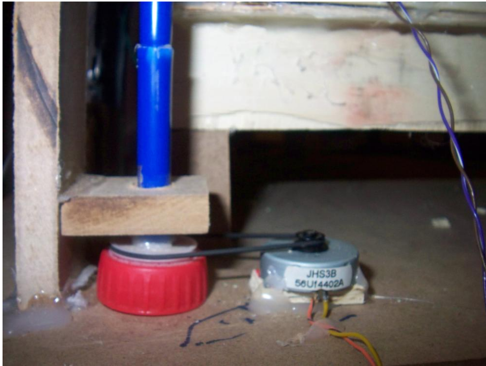
Mecanismo del cabezal de transporte Se han usado dos motores iguales
