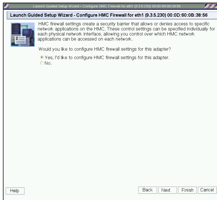
Figura 31. HMC pantalla de activación del Cortafuegos
