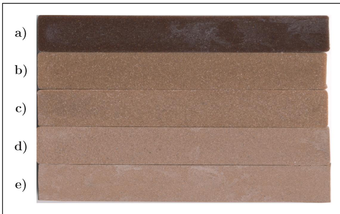
**Figura IV.59.** Aspecto macroscópico de las muestras de biocompuestos de PLA/HCA antes a) y después del proceso de envejecimiento por inmersión en agua, b) 10; c) 20; d) 30 y e) 40% en peso de HCA.
