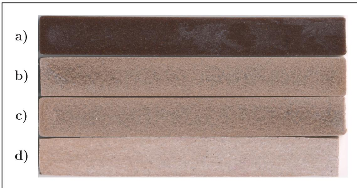
**Figura IV.60.** Aspecto macroscópico de las muestras de biocompuestos PLA/HCA/ELO antes, a) y después del proceso de envejecimiento por inmersión en agua, b) 7,5; c) 15 y d) 22,5% en peso de ELO.
