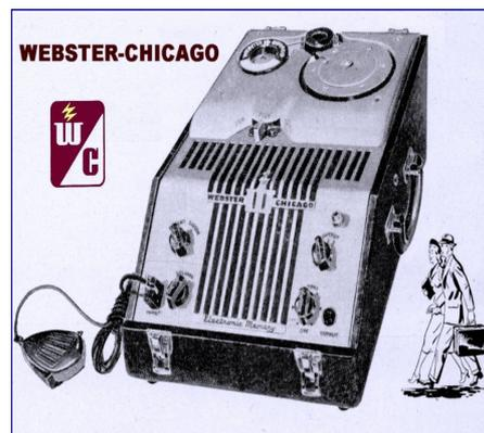
Imagen 15. Model 80 Wire Recorder (1948) Primer modelo de reproductor para este tipo de grabación creado por Webster-Chicago Corporation<sup>12</sup>
