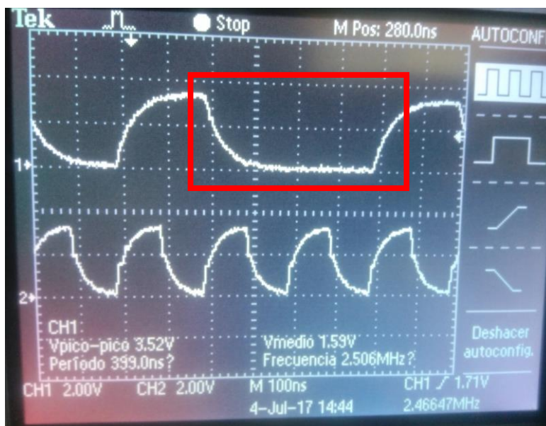
Figura 6.6: Transición de ‘0’ a ‘1’ captada por el osciloscopio, a 5 MHz.
