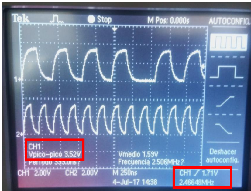
Figura 6.5: Pulsos generados por el transmisor con una frecuencia de reloj de 5 MHz.
