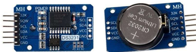
Ilustración 5 Módulo RTC I2C DS3231
