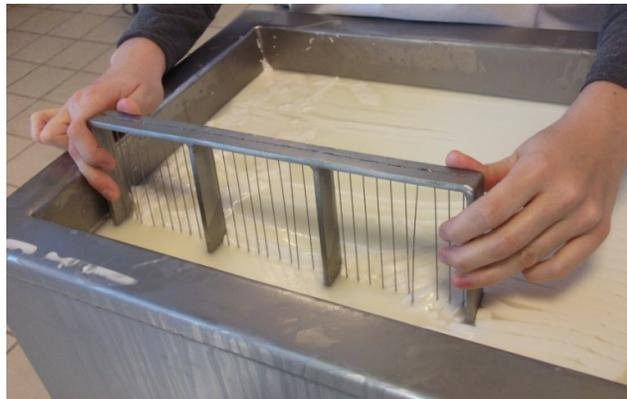
**Figura 5.** Operación de cortado mediante lira manual.
