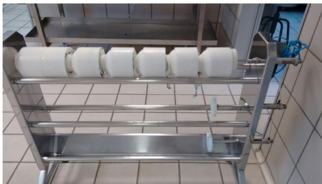
**Figura 6.** Prensa hidráulica horizontal empleada para el queso de Tronchón.
