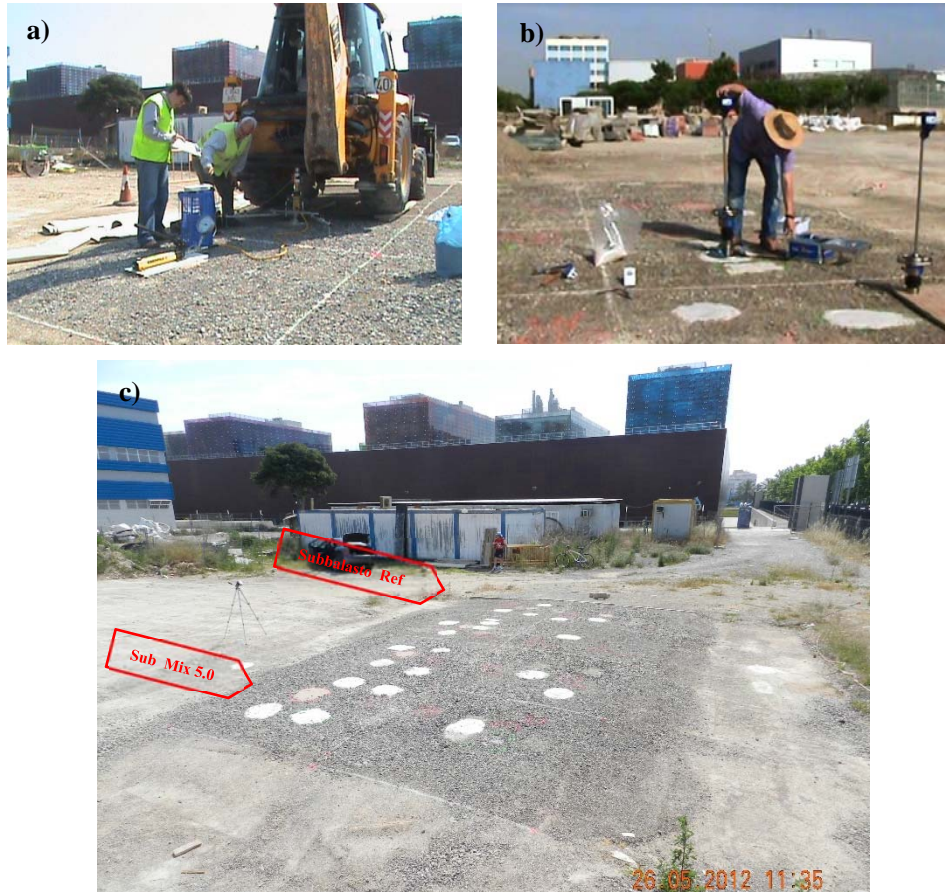
Figura 3.9. Ensayos de campo. a) Placa de Carga Estática. b) Placa de Carga Dinámica (LFWD). c) Tramo de pruebas experimental en la UPV.
