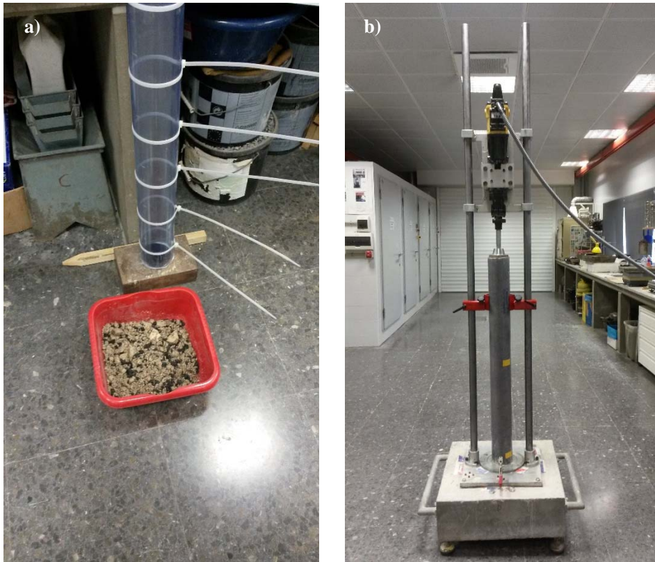
Figura 3.15. Preparación de las probetas: a) Mezcla de la submuestra subbalasto-caucho; b) Equipo de compactación utilizado.
