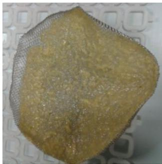
**Figura 6.3.** Restos de sólidos en suspensión presentes en las aguas residuales de salmuera de fermentación.
