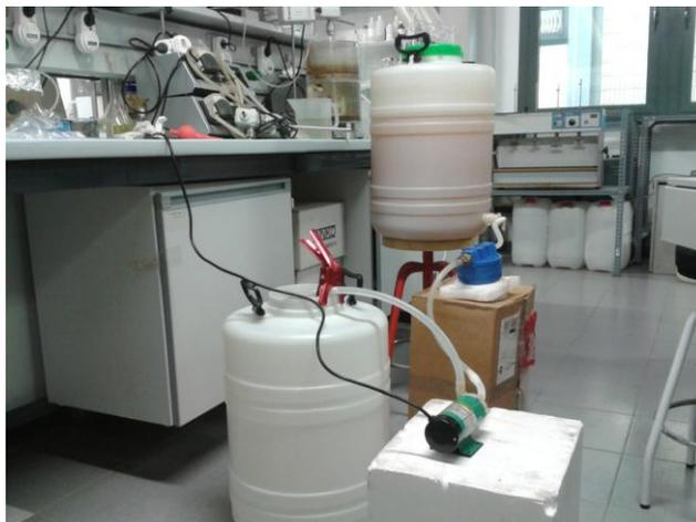
**Figura 6.5.** Proceso de filtración de una muestra de salmuera de fermentación.
