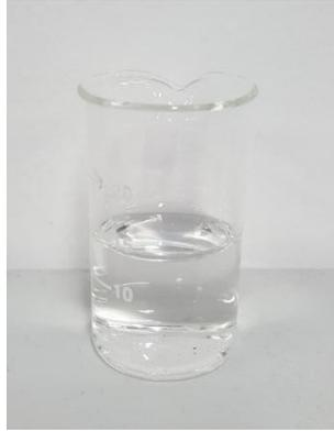
**Figura 6.89.** Permeado de la NF obtenido con la membrana NF245 en el ensayo a concentración con 3 L de alimentación a 15 bar,  $1.5 \text{ m}\cdot\text{s}^{-1}$  y  $25^\circ\text{C}$ .
