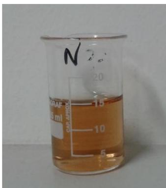
**Figura 6.91.** Aspecto del permeado de la NF obtenido con la membrana NF245 a 15 bar,  $1.5 \text{ m}\cdot\text{s}^{-1}$  y  $25^\circ\text{C}$ , tras 24 horas a temperatura ambiente.
