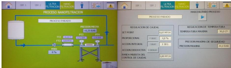
**Figura 5.11.** Sinóptico y pantalla de configuración del proceso de nanofiltración.
