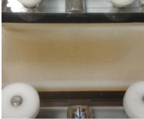
**Figura 6.41.** Aspecto de la membrana UP005 durante la ultrafiltración de un volumen de alimentación de 50 L a 3 bar,  $2.2 \text{ m}\cdot\text{s}^{-1}$  y  $25 \text{ }^\circ\text{C}$  con concentración de la alimentación.
