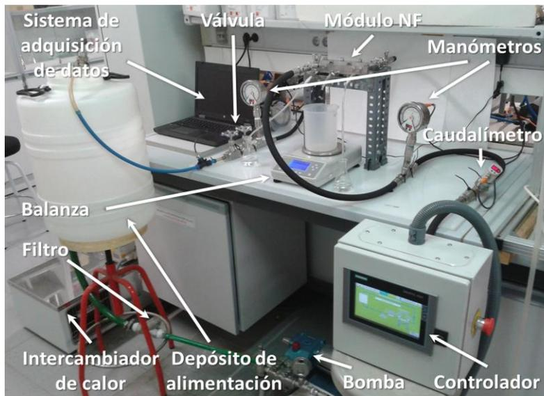
**Figura 5.12.** Planta de nanofiltración.
