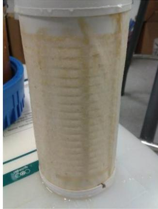
**Figura 6.4.** Sólidos en suspensión retenidos por el filtro de 60  $\mu\text{m}$  para una muestra de salmuera de fermentación con baja cantidad de SST.
