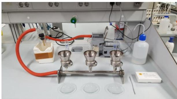
Figura 5.14. Montaje del equipo de filtración a vacío.
