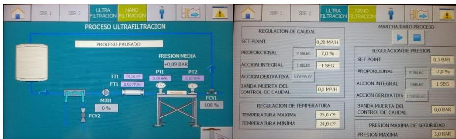
Figura 5.7. Sinóptico y pantalla de configuración del proceso de ultrafiltración.
