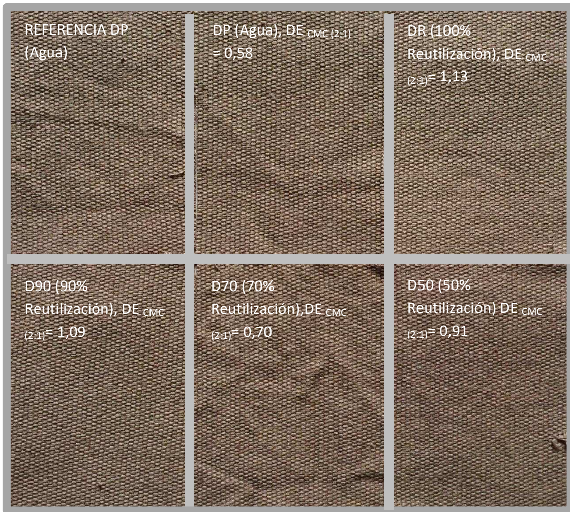
Figura 8.35. Muestras de tejidos de algodón tintados y valores de diferencias de color DE_{CMC(2:1)} en las tinturas realizadas con las disoluciones DP, DR, D90, D70 y D50, Iluminante D65 10º Factor de tolerancia 1
