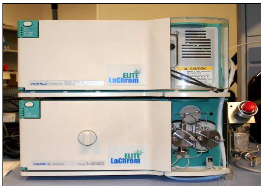
Figura 7.4. Sistema de HPLC Hitachi Lachrom-Elite equipado con columna Lichrospher 100 RP-18 (5 \mu\text{m} ) y sistema de detección Diodo Array L-2450 empleado para las medidas cromatográficas.
