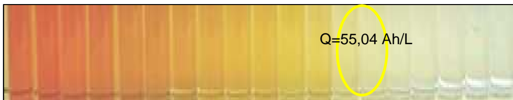
Figura 8.1. Decoloración obtenida a lo largo del proceso de electrolisis del Procion Yellow HEXL en concentración 1,4g/L al aplicar una carga máxima de 74Ah/L
