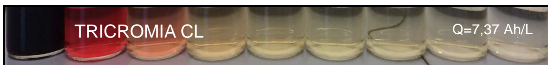
Fig. A1.1. Evolución de la degradación y decoloración de las muestras de la disolución, TRICROMIA CL a lo largo del proceso de electrolisis hasta una carga de 7,37Ah/L.
