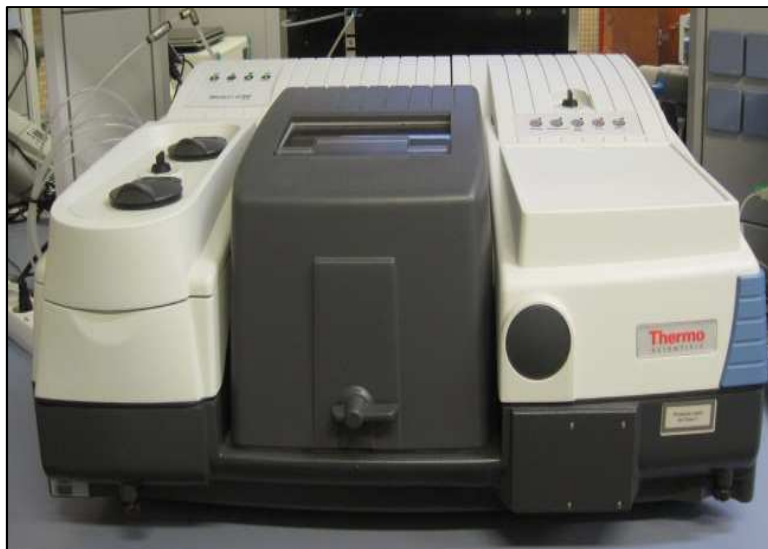
Figura 7.3. Espectrómetro FTIR NICOLET 6700 con detector DTGS
