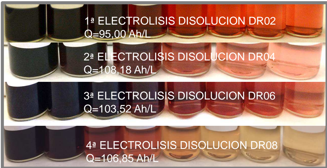
Fig. 8.38. Evolución de la degradación y decoloración de las muestras obtenidas a lo largo del proceso de electrolisis de cada una de las disoluciones DR02, DR04, DR06 y DR08
