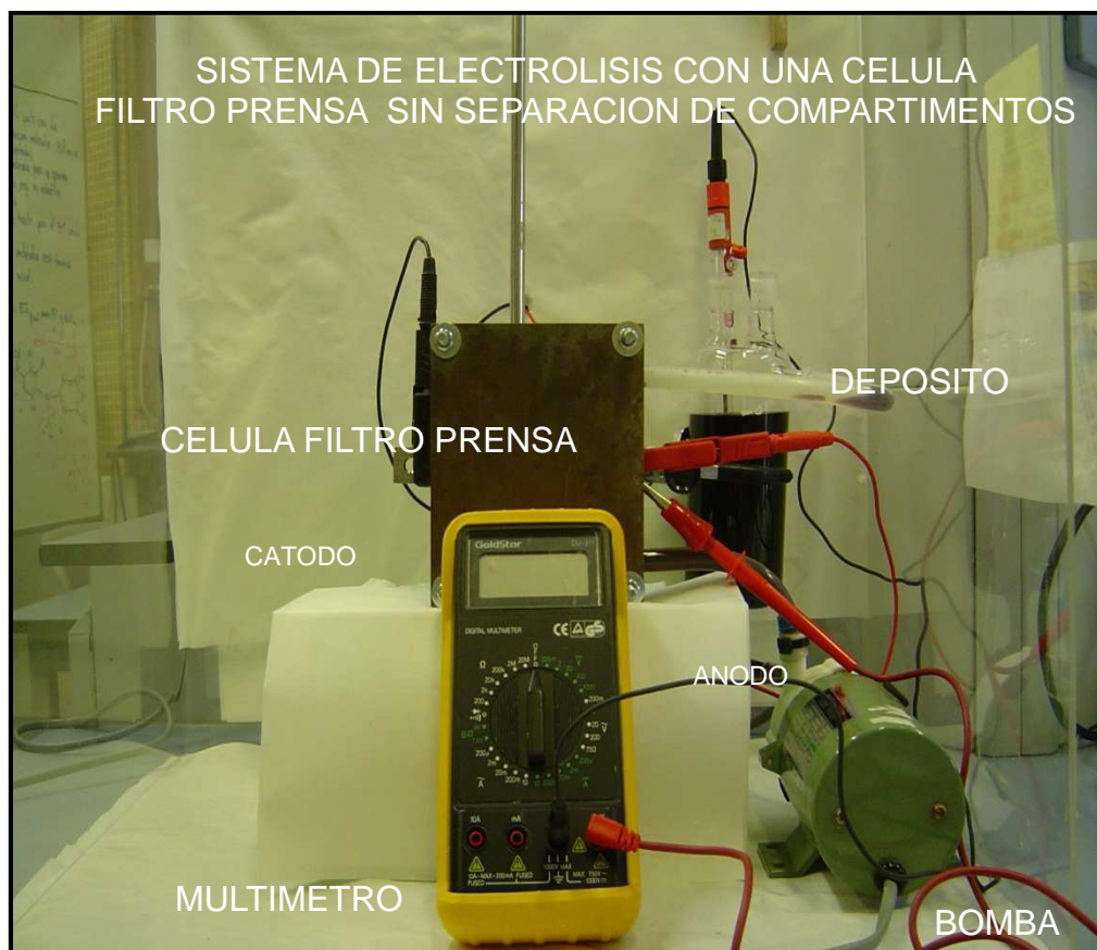
Figura 7.15. Sistema de electrólisis empleado con una célula filtro prensa sin separación de compartimentos.
