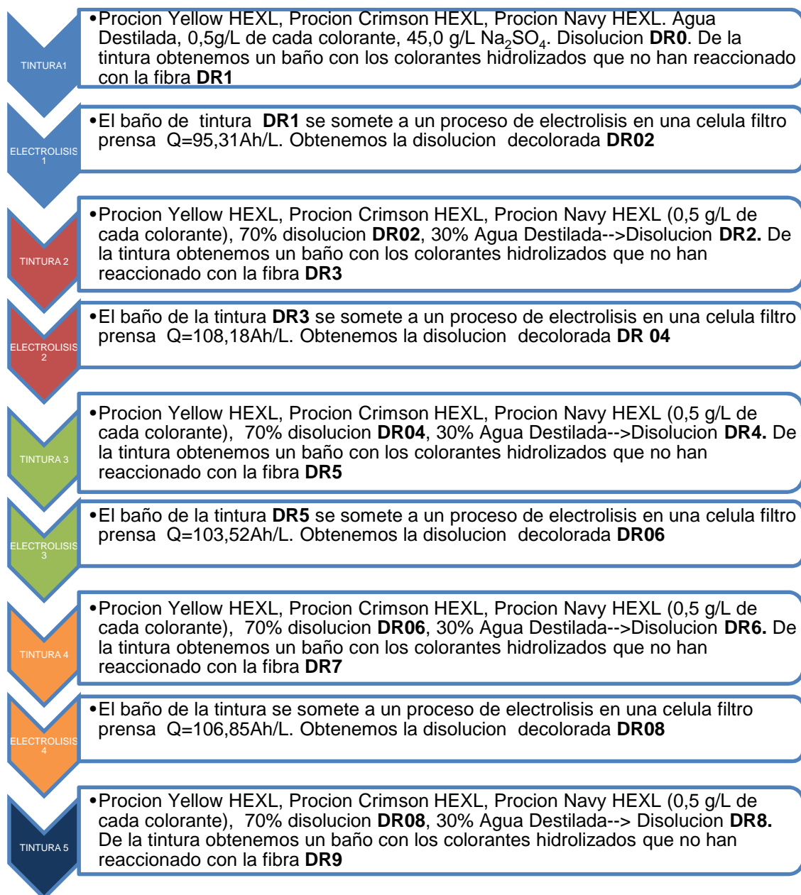
Figura 8.36. Proceso seguido para realizar cuatro reutilizaciones de un baño de tinte con colorantes (Procion Yellow HEXL, Procion Crimson HEXL, Procion Navy HEXL) hidrolizados consistente en tinturas y posteriores degradaciones electrolyticas.
