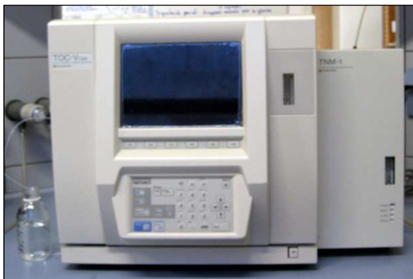
Figura 7.7. Analizador de Carbono Orgánico Total (COT) y Nitrógeno total (TN)
