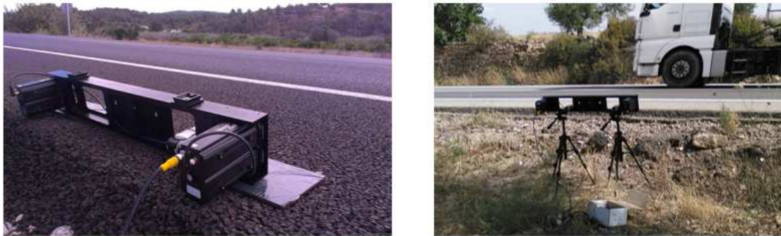
Figura 62. Láser colocado sobre la calzada con unos pequeños calzos y láser colocado sobre trípode.
