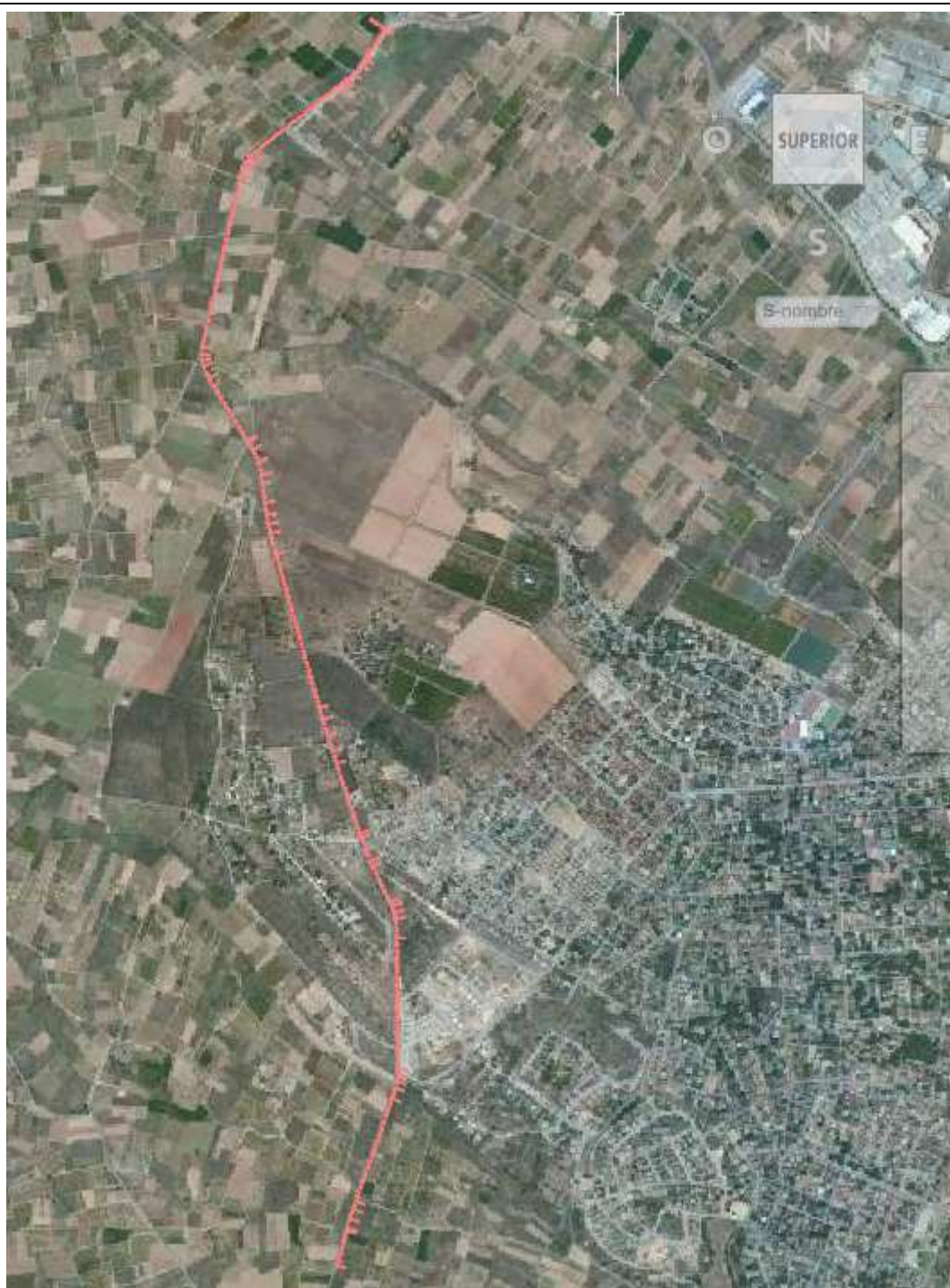
Figura 230. Restitución geométrica de la alineación horizontal de la CV-372 La Pobla de Vallbona-Ribarroja.
