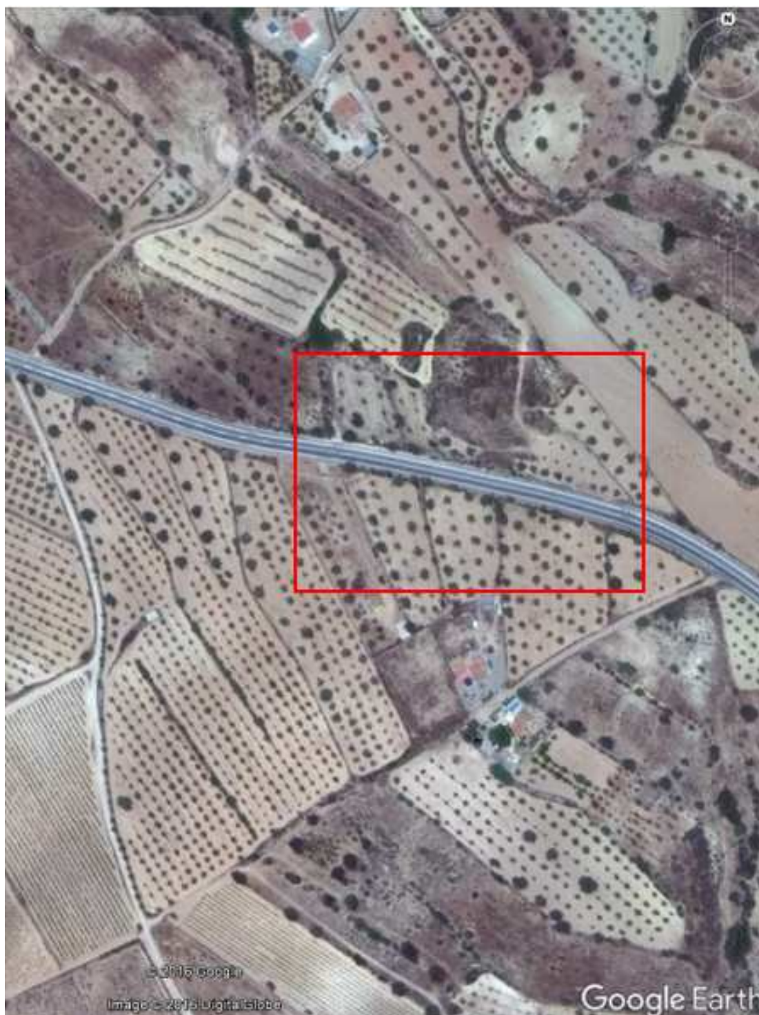
Figura 72. Curva de radio 1120 m de la CV-345.
