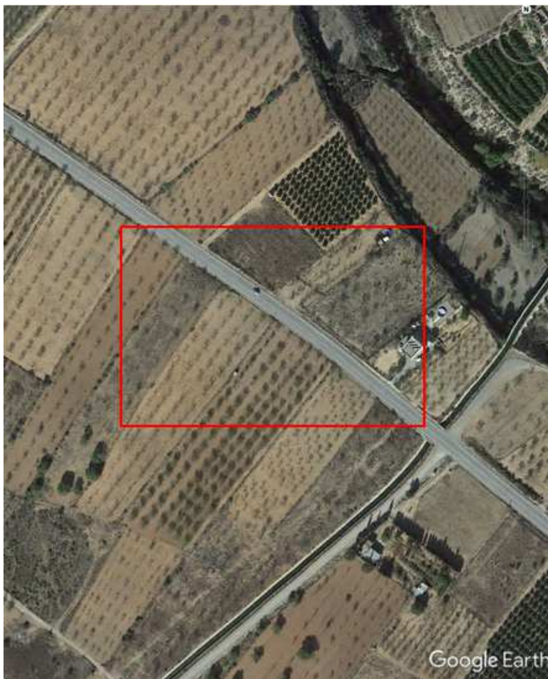
Figura 74. Curva de radio 816 m de la CV-345.
