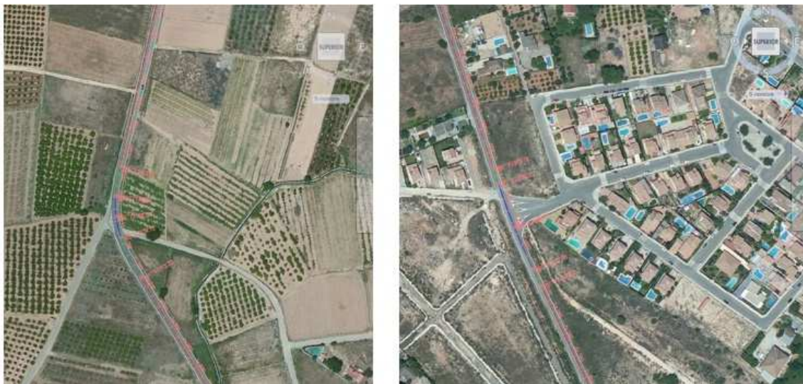
Figura 120. Ejemplos de curvas eliminadas del estudio por la influencia que puedan tener las intersecciones.
