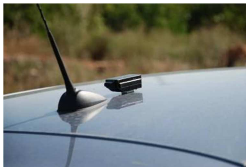
Figura 41. Dispositivo GPS colocado en el techo del vehículo participante.
