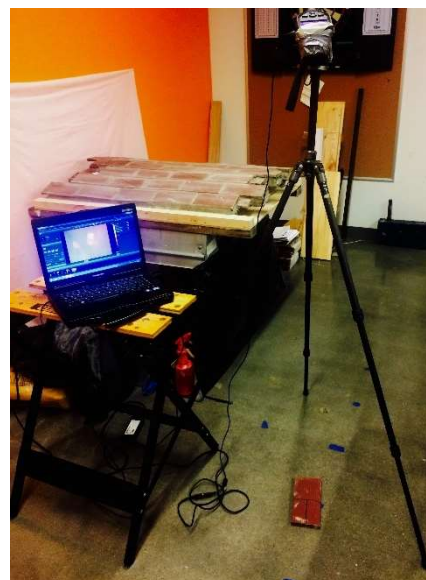
Figura 4.3-5 Fotografía del proceso de pre-enfoque. En la pantalla del PC portátil puede observarse la huella digital aplicada al ladrillo.
