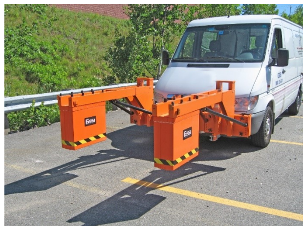
Figura 2.4-33 Modelo SIR 30 de GSSI con antenas RadarScan-horn de 1 GHz y 2 GHz. Los rangos de profundidad son 0 -0,9 m y de 0 - 0,75 m respectivamente (GSSI).
