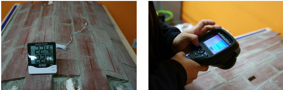
Figura 4.3-1 Las fotografías muestran diferentes fases en el método de la obtención de la emisividad de la superficie de la bóveda.
