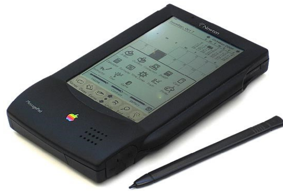
Figura 2.3-34 Apple Newton pen, lanzado en 1993. Siendo el predecesor de los sistemas posteriores, carecía del software gráfico necesario para aplicaciones arquitectónicas efectivas (Apple).
