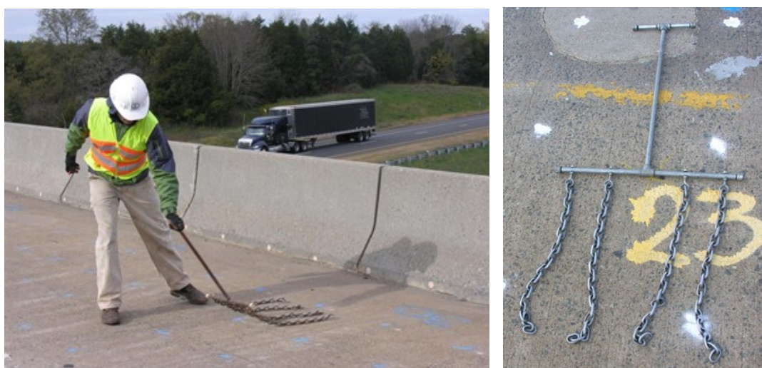
Figura 2.4-50 Método del arrastre de cadena para detectar delaminaciones (Rutgers University).
