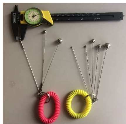
Figura 4.4-1 El juego de bolas del instrumento de IE que se utiliza tiene 8 esferas de tamaños: 3, 4, 5, 6, 8, 9, 11 y 12 mm
