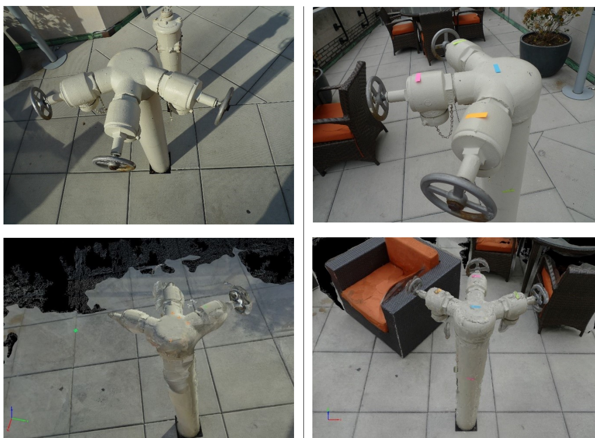
Figura 2.3-25 La columna de la izquierda muestra, en la imagen superior, la fotografía de una tubería sin referencias. Se tomaron 73 fotografías de las cuales el software (Pix4D) utilizó 59 para generar el modelo mostrado en la imagen inferior. En la columna de la derecha la imagen superior corresponde a la fotografía de la misma tubería, pero con identificadores de diferentes colores. El proceso de toma de datos fue idéntico al caso de la izquierda. El software generó el modelo de inmediatamente inferior. Como puede observarse, el resultado es de mejor calidad debido a la existencia de identificadores.
