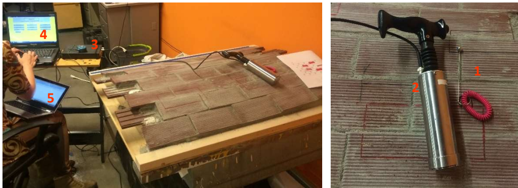
Figura 4.4-7 El equipo del test IE se compone de las bolas de impacto (1), un receptor (2), una unidad de procesado (3), un ordenador con el software IE como unidad de control (elección de valores para los parámetros, registro, procesado y análisis) (4). En este caso se utilizó un segundo ordenador portátil para registrar con Microsoft Excel los diferentes tests (5).
