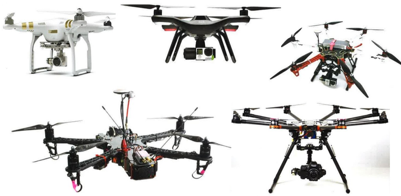
Figura 2.6-5 De izquierda a derecha, de arriba abajo: DJI Phantom 3, 3DR Solo, DJI F550 hexacoptero, TBS Discovery Pro y DJI S-1000.
