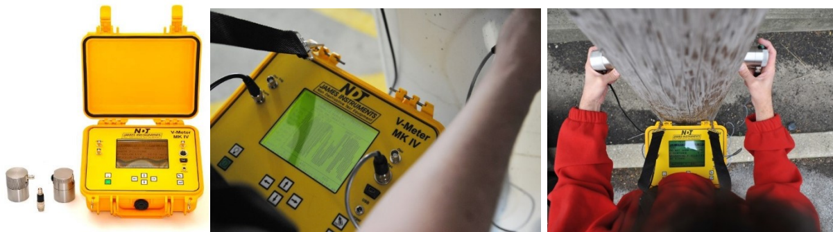
Figura 2.5-39. Equipo V-Meter Mk IV Pulse Velocity Meter de NDT James Instruments, tiene display automático, una precisión de 0,1 microsegundos y pesa 2.75 Kg (NDT James Instruments).
