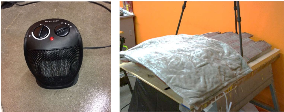
Figura 4.3-6. Fuentes de calor en la termografía activa: por convección con calentador cerámico (izquierda) y por contacto con manta eléctrica (derecha).
