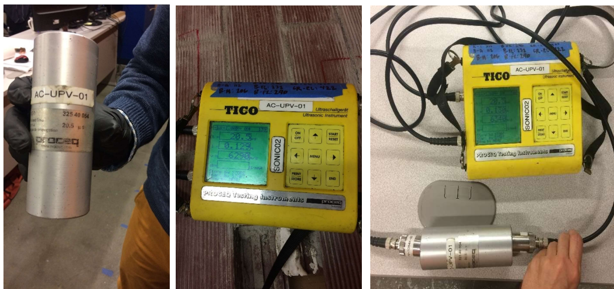
Figura 4.5-1 El proceso de calibración del equipo se lleva a cabo al comienzo de cada sesión con un bloque de calibración siguiendo el método descrito por el aparato. Los valores mostrados en la pantalla deben coincidir con los especificados en el bloque.
