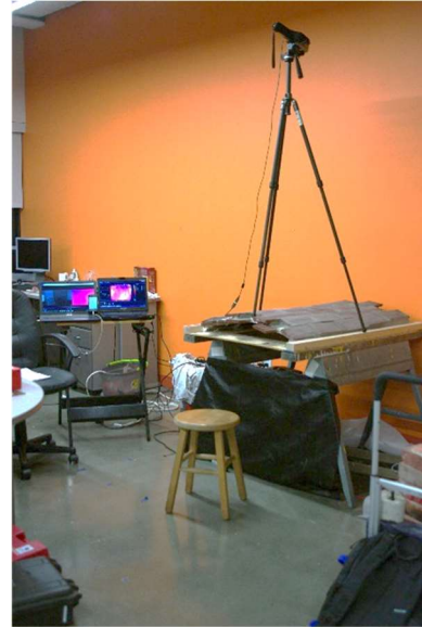
Figura 4.3-7 Imagen general del proceso de toma de termogramas desde el trasdós.
