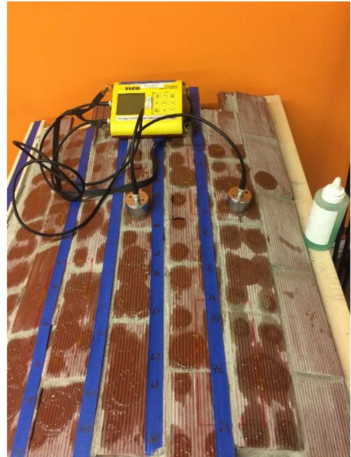
Figura 4.5-5 Imagen en la que se observa el equipo del test UPV, compuesto de unidad central, transductores y gel acoplante.
