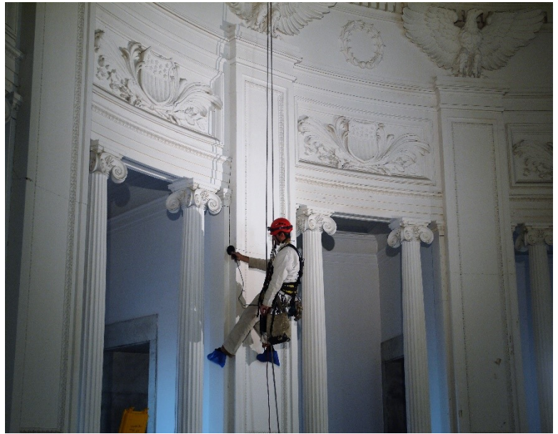
Figura 3.2-4 Técnico utilizando un dispositivo de detección de metales.
