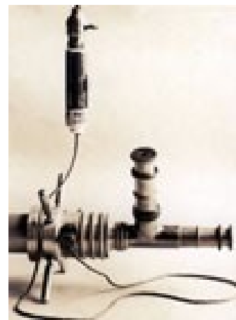
Figura 2.3-2 Primer Boroscopio para inspecciones de rotor de turbina, 1921. (Lenox, 2016)
