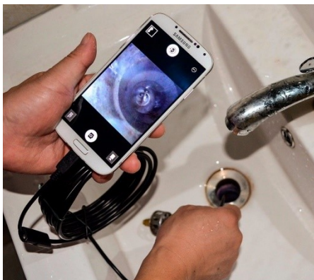
Figura 2.3-6 Video boroscopio de bajo coste de la marca Android para usar con teléfonos móviles (Catchnew).
