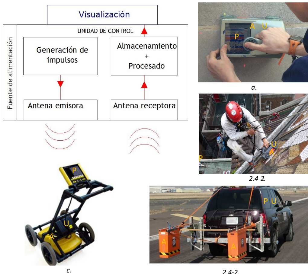
Figura 2.4-2 Esquema básico de componentes de un equipo GPR. a. Modelo GSSI Structurescan Mini, que alberga todos los componentes en una misma carcasa de 15 x 17 x 22 cm b. Modelo GSSI Structurescan Standard, cuya pantalla de visualización se encuentra en una pantalla independiente del resto del equipo. c. Modelo Imx100 de Sensors and software. Con antenas, unidad de control y pantalla de visualización en diferentes carcasas, todas ellas montadas sobre un carro. d. Modelo GSSI Radar Scan 30, con todos sus componentes independientes. U: Unidad de control. A: Antena. P: Pantalla de visualización (B. de Miguel, B. de Miguel, Sensors and Software, GSSI)
