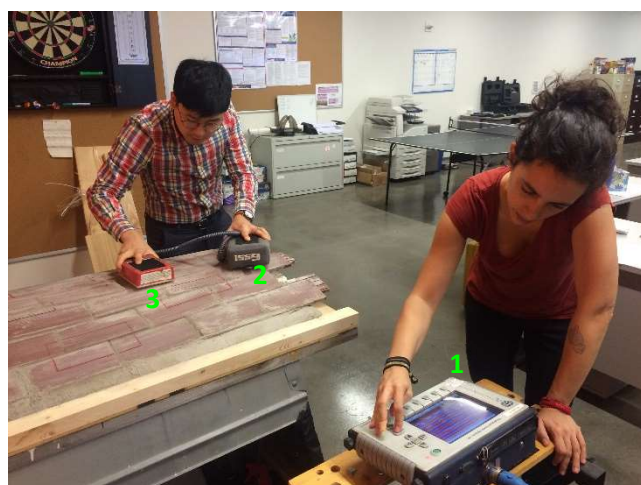
Figura 4.2-6 El equipo de GPR utilizado consta de 1. Unidad central GPR GSSI SIR 3000, 2. antena GSSI 2,6 GHz y 3. Emisor/receptor GSSI (S. Cole).
