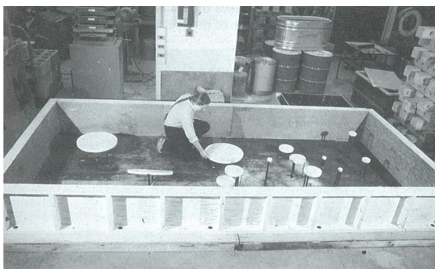
Figura 2.5-10 Tests de laboratorio. En la imagen se muestra el encofrado de una losa de 0,5 m de profundidad, que contiene varios discos de aislante a modo de simulación de grietas planas u oquedades a diferentes profanidades (Sansalone, M.; Carino, N.J., 1986).
