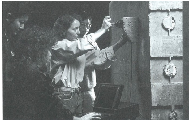
Figura 2.5-11 Imagen del primer modelo de sistema impacto-eco, manipulado por su inventora M. Sansalone, en una investigación para detectar oquedades en los tendones de un elemento post-tensado. Kay Chernash (Sansalone & Streett, 1997)
