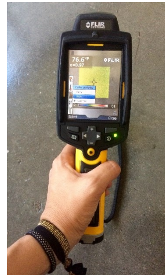
Figura 2.4-13 Diferentes escalas cromáticas de representación en el modelo FLIR640: grey, rainbow y iron.
