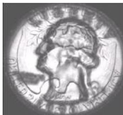
Figura 2.5-34 Imágenes C-scan de una moneda de veinticinco céntimos de dólar. Ambas imágenes fueron tomadas utilizando la técnica de reflexión de ultrasonidos (pulse-echo) con el transductor situado en el lado de la cara de la moneda. Para la imagen de la izquierda, la profundidad de estudio se situó en la superficie de la cara de la moneda, para capturar la amplitud del sonido reflejado en esa superficie. En el C-scan de la derecha, la profundidad de estudio se movió para registrar la intensidad del sonido reflejado de la cara posterior de la moneda. Sigue apareciendo la cara dado que el sistema recoge las anomalías que encuentra en su trayectoria hasta el plano de estudio (National Science Foundation, 2014).
