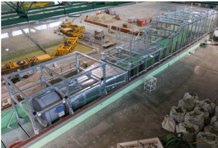
Figura V.5. Canal de oleaje y viento de grandes dimensiones. Vista general (fuente: CEDEX, 2017).
