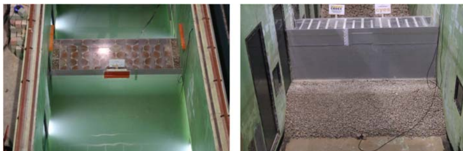
Figura V.12. Modelos de estructura vertical clásica (CEDEX, 2011 y 2012).
