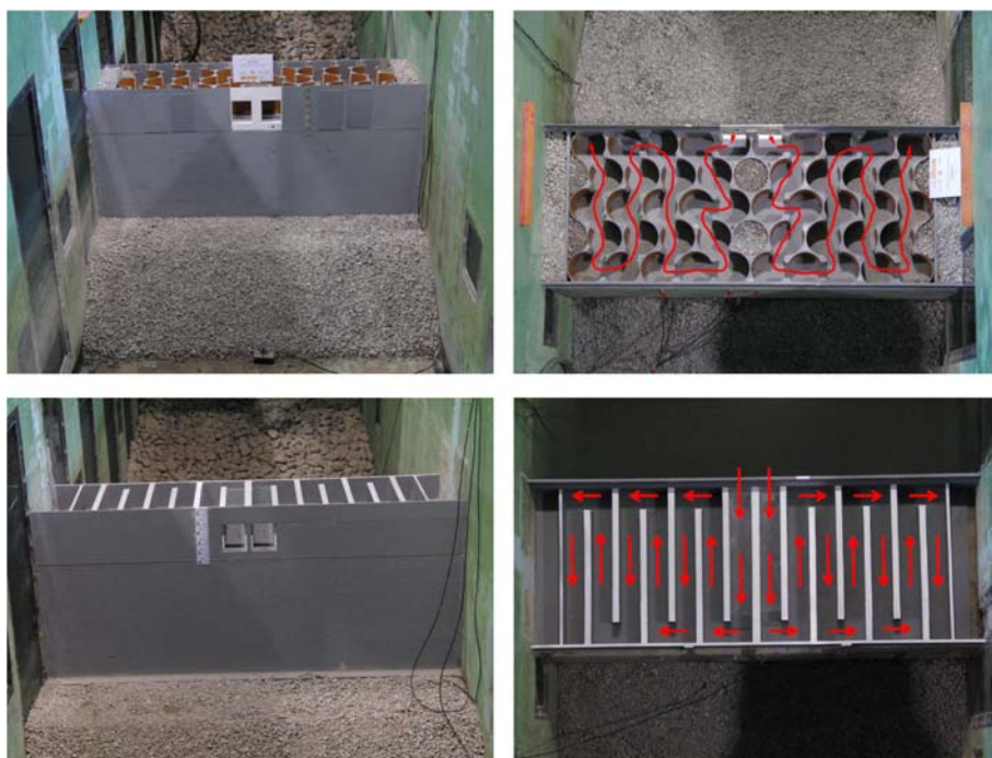
Figura V.13. Modelos de estructuras ARJ-R-CI-1 de celdas circulares (superior) y ARJ-R-CU-1 de celdas cuadradas (inferior) con diseño de dos circuitos disipativos largos (CEDEX, 2011 y 2012).
