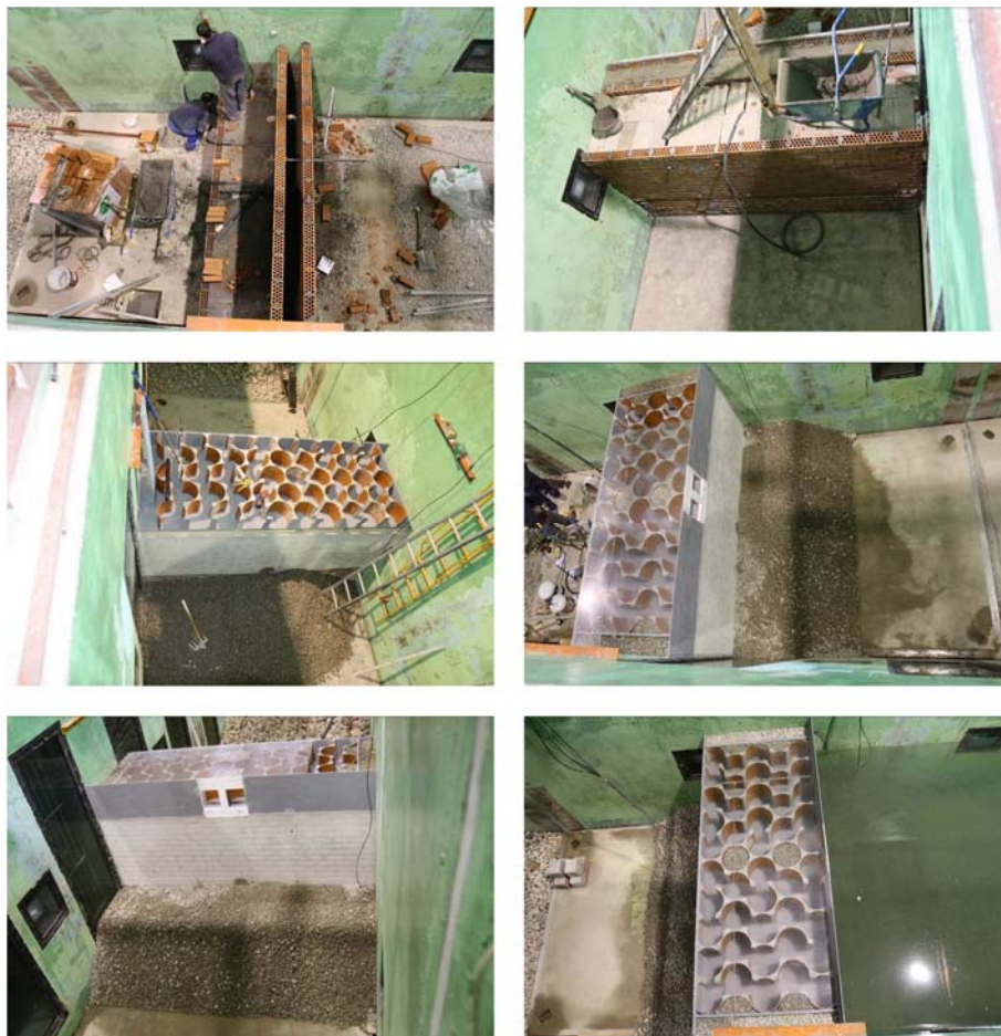
Figura V.11. Construcción del modelo. Impermeabilización de la banqueta y construcción de la sección ARJ-R estanca.
