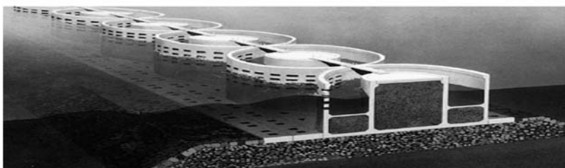
dique del puerto de Nagashima (Japón).
