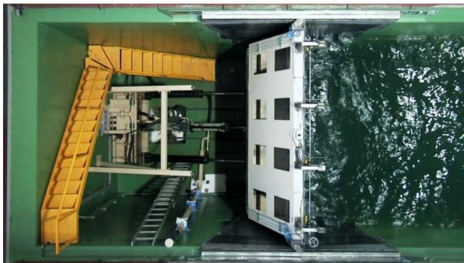
Figura V.6. Vista cenital de la pala generadora de ondas estanca. (fuente: CEDEX, 2017).
