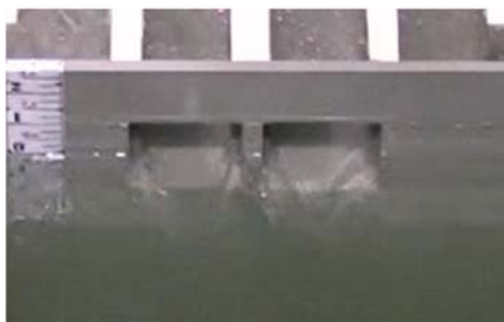
Figura V.32. Imagen de la grabación del ensayo SRR correspondiente a la estructura ARJ-R-CU-2, con T=90s . Flujo vaciante a la salida de las cámaras.
