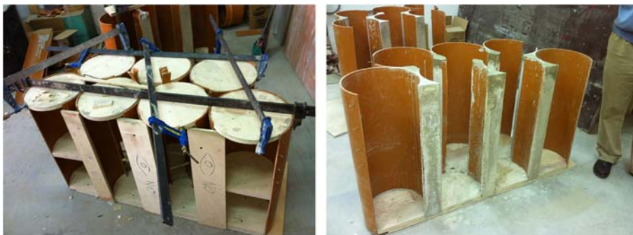
Figura V.10. Construcción del modelo. Celdas circulares.
