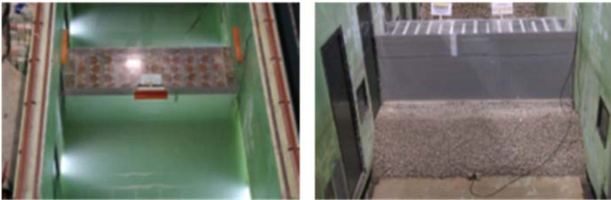
Figura A-1.9. Modelo a escala 1/11.6 de la estructura vertical completamente reflejante (REF).
