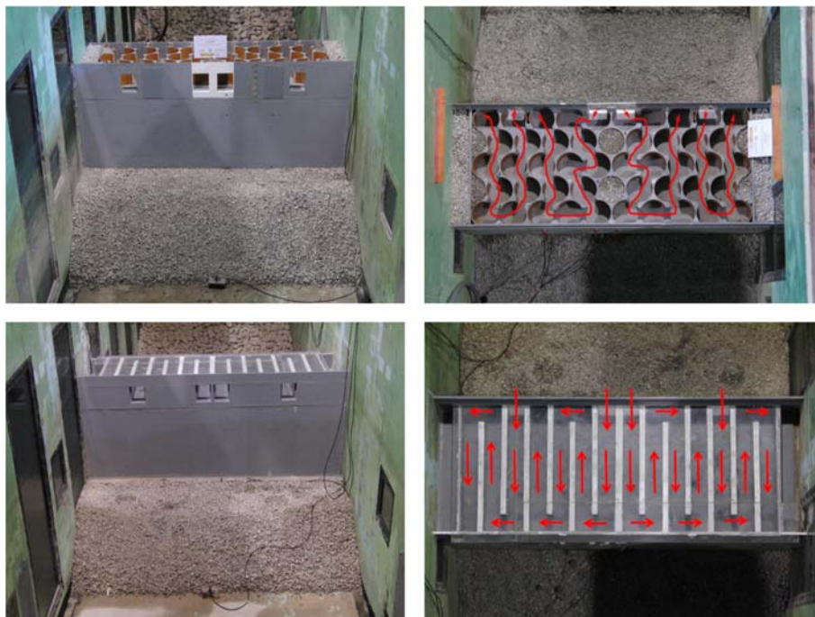
Figura V.14. Modelos de estructuras ARJ-R-CI-2 de celdas circulares (superior) y ARJ-R-CU-2 de celdas cuadradas (inferior) con diseño de cuatro circuitos disipativos largos (CEDEX, 2011 y 2012).
