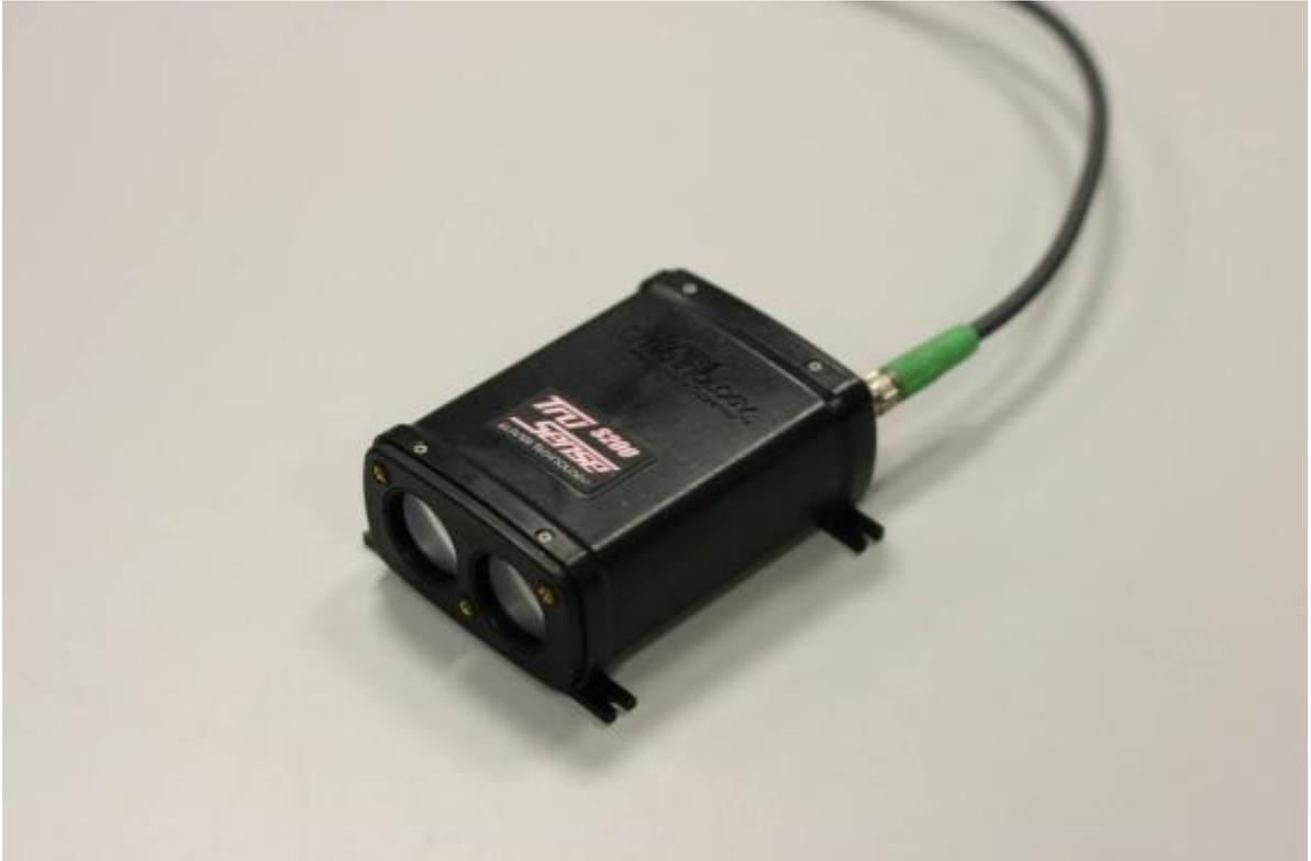
*Figura 8. Distanciómetro laser S200 de Laser Technology Inc.*
