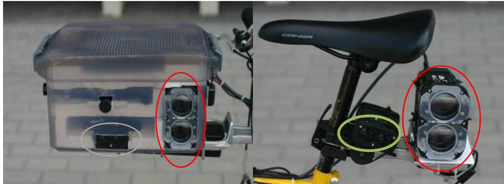
*Figura 56. Distanciómetros (verde) y medidores de velocidad (rojo).*
