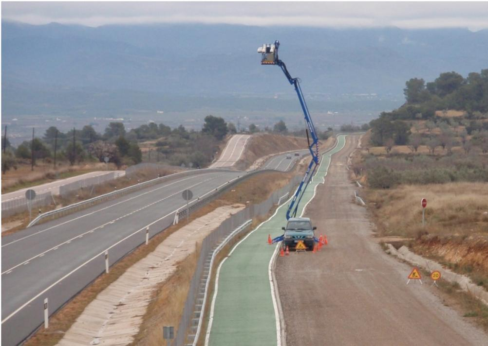
*Figura 43. Cámaras sobre plataforma móvil.*
