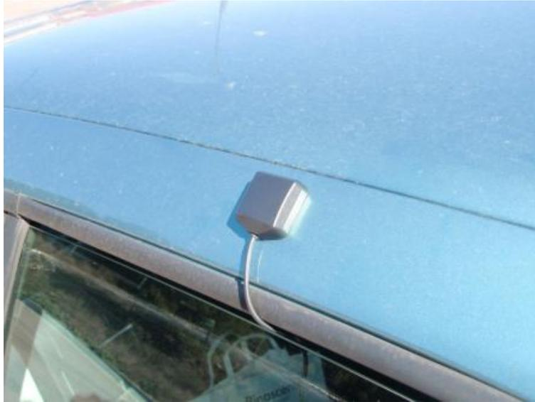
*Figura 5. Antena del receptor GPS del sistema VBOX.*
