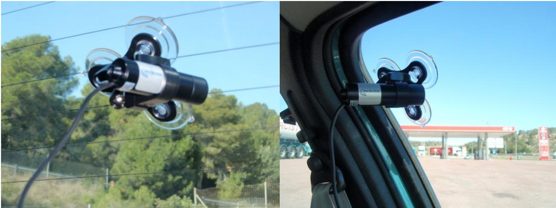
*Figura 45. Vistas de las cámaras de video digitales instaladas en el interior de un vehículo instrumentado.*
