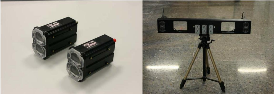
*Figura 7. Vista del sensor Speed System T100/T200 y montaje sobre soportes para realizar mediciones desde el exterior de la plataforma.*
