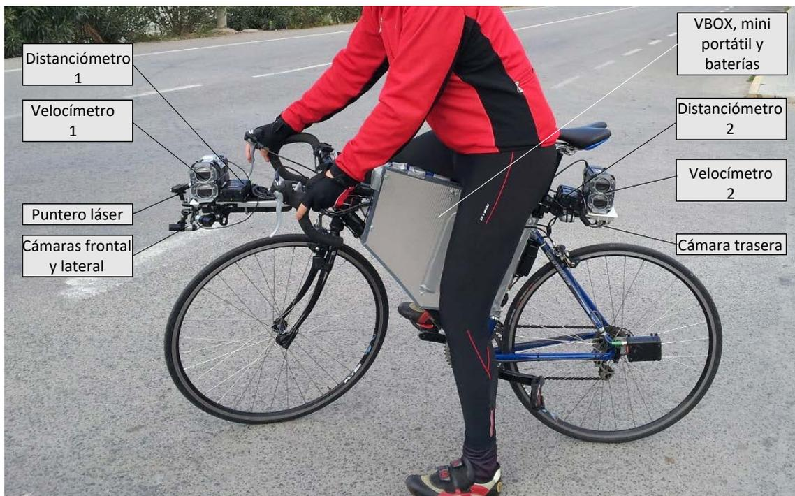
*Figura 65. Bicicleta de carretera completamente instrumentada antes de una salida.*
