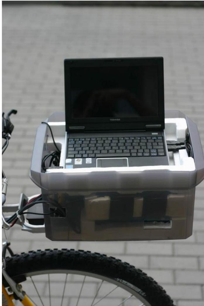
*Figura 53. Ordenador portátil y dispositivo VBOX.*
