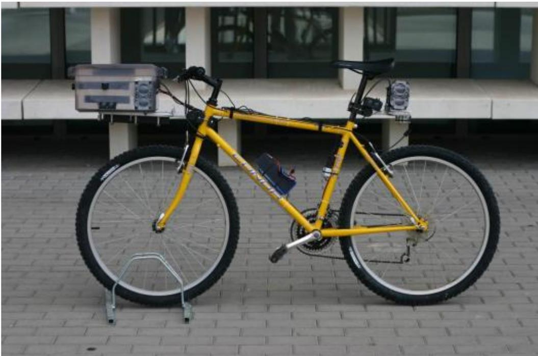
*Figura 59. Bicicleta completamente instrumentada.*
