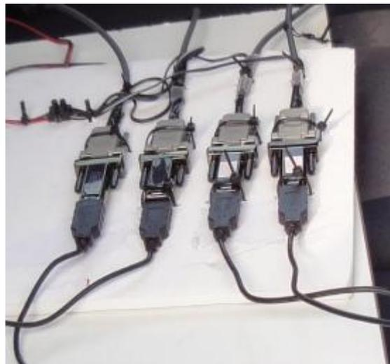
*Figura 9. Conexiones necesarias para la comunicación entre los distanciómetros y el ordenador portátil.*
