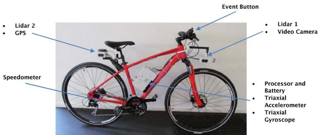
Figura 33. Instrumentación de la bicicleta, N.Z. Transport Agency (2016).
