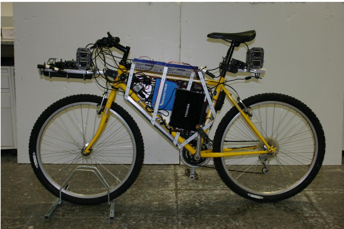
*Figura 64. Nueva disposición de la instrumentación en la bicicleta de montaña.*
