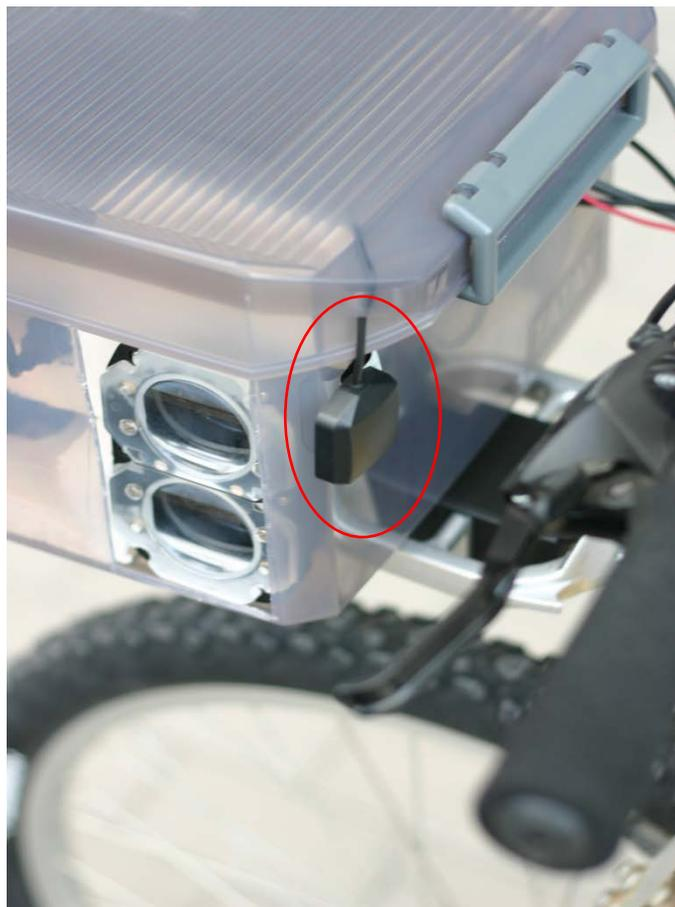
*Figura 57. Dispositivo GPS.*
