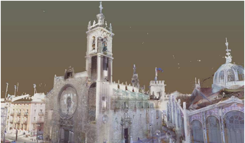
04.7. Perspectiva de la Nube de puntos de los Santos Juanes y su entorno. Autor (2015).
