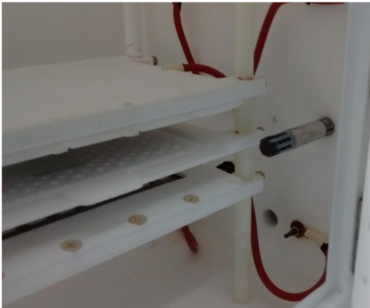
Figura 4.5 Detalle de colocación de sonda de humedad Vaisala HMP110 en el interior de la cámara
