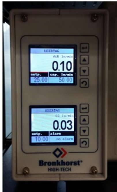
Figura 3.18 Controlador del mezclador de gases. BRONKHORST HI-TEC E-8103-2A-1A-0.
