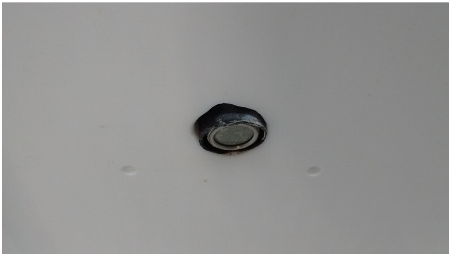
Figura 4.14 Detalle de la sonda de temperatura de infrarrojos en el interior de la cámara
