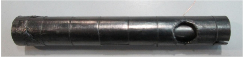
Figura 3.10 Tubo de cuarzo recubierto de grafito APPJ-NTP.
