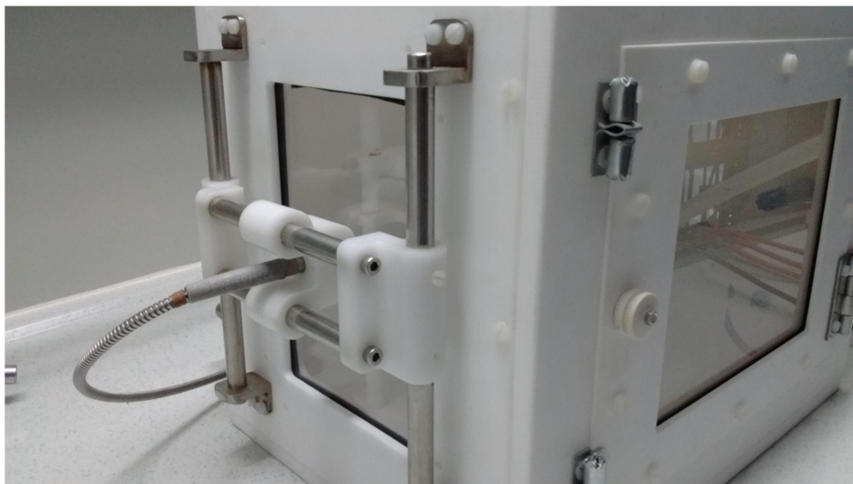
Figura 4.8 Detalle de colocación del coseno corrector del Espectrómetro Ocean Optics Maya 2000 Pro.
