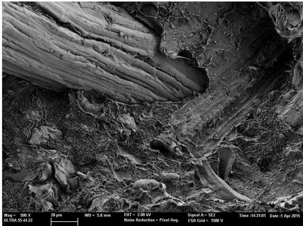
**Figura 31.-** Morfología de la superficie de la rotura por impacto de la muestra BioPE/30% *Thymus Moroderi*, con PEA como agente de compatibilización (500X).
