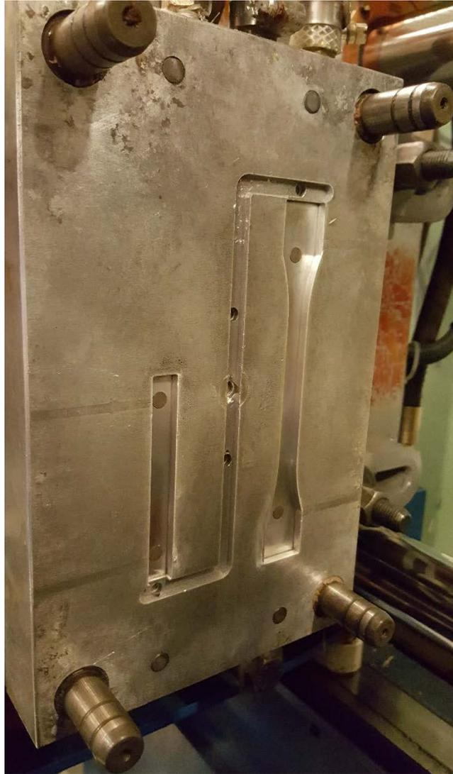
**Figura 15.-** Molde de inyección de probetas normalizadas de tracción y de flexión-impacto.
