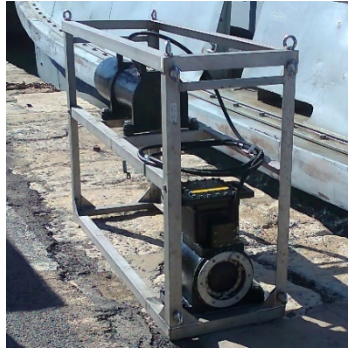
Figura 4.19. Imagen del proyector acústico submarino GW155 MK.2 de Gearing & Watson Electronics montado sobre el bastidor de acero. En la parte de abajo el transductor unido por un cable a uno de los compensadores colocado en la parte superior del bastidor.
