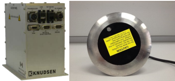
Figura 4.2. A la izquierda ecosonda ROVER de Knudsen Engineering usada y a la derecha transductor SS264W de Airmar.
