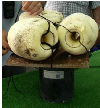
Figura 4.18. Imagen del transductor DT4 single-beam de Biosonics montado en la plataforma antes de ser colocado de manera dorsal.
