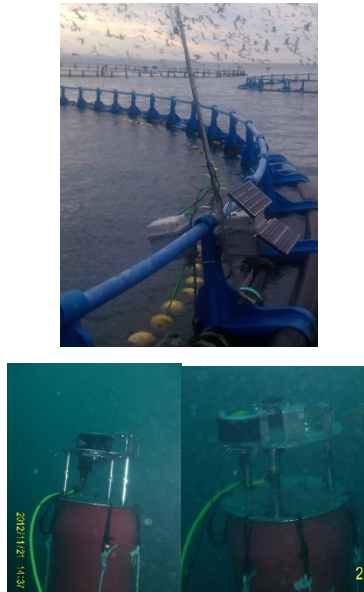
Figura 4.7. Detalle de las cajas que contienen los equipos, los módulos solares y la antena (izquierda) y de la plataforma utilizada para montar el transductor y la cámara (arriba derecha y abajo).
