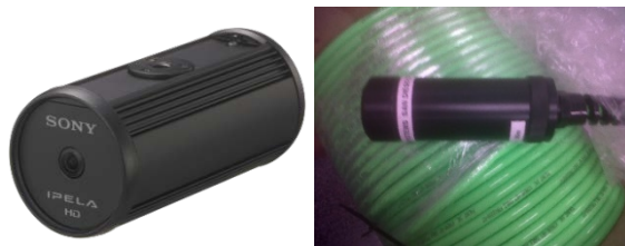
Figura 4.3. Detalle de la cámara antes de encapsularse, y de la cámara unida al cable y preparada para sumergirse.
