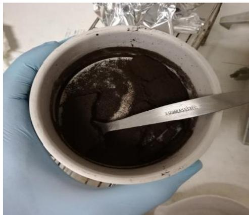
**Imagen 20.** Sólido resultante de la filtración en el Buchner
