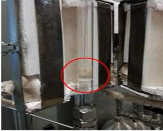
**Imagen 13.** Reactor tubular con la cantidad de BM3 dentro del horno
