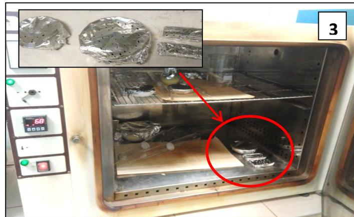
**Imagen 8.** Mufla para el secado de las muestras
