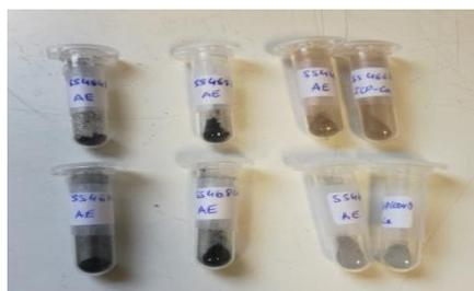
**Imagen 9.** Muestras depositadas en ependorfs para los análisis de AE, ICP y TG
