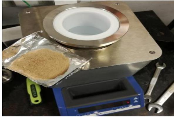
**Imagen 16.** Cantidad de biomasa para introducir al reactor de HTC mezclada con el agua en el cilindro de teflón interior
