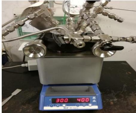
**Imagen 15.** Reactor batch para el proceso de HTC
