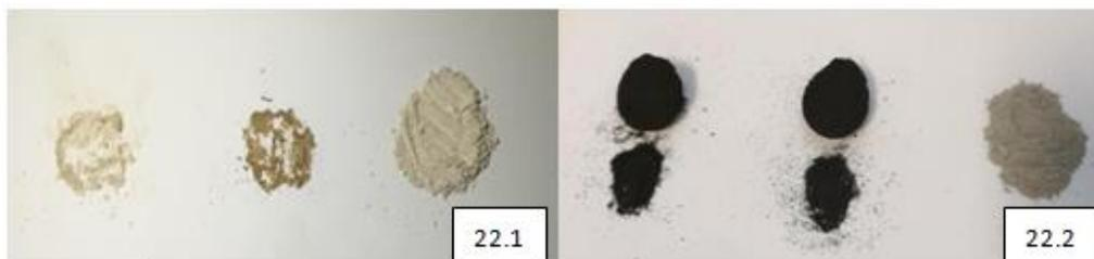
**Imagen 22.** Apariencia física de las muestras de biomasa después del análisis de volátiles (22.1) y cenizas (22.2)
