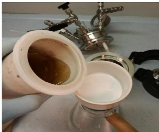
**Imagen 19.** Cilindro de teflón del reactor HTC y montaje de filtrado al vacío
