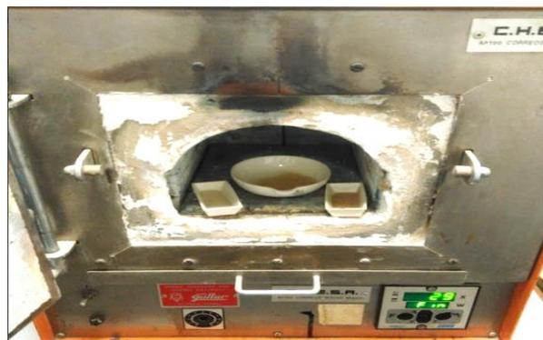
**Imagen 11.** Horno para la determinación de cenizas con las tres muestras de biomásas depositadas en cápsulas de porcelana
