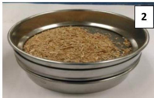
**Imagen 7.** Tamiz de 0,25mm con el colector inferior
