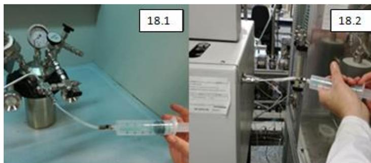
**Imagen 18.** Recolección de los gases de salida (18.1) y pinchazo en el CG (18.2)
