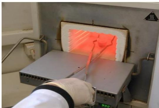
**Imagen 10.** Mufla especial para la determinación de volátiles con una muestra en el interior
