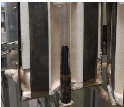
**Imagen 14.** Apariencia final del residuo sólido de la muestra una vez realizada la gasificación
