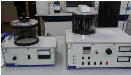
Fig.1.1.2.11. Equipo Polaron Range con deposición de oro/paladio o carbón para SEM
