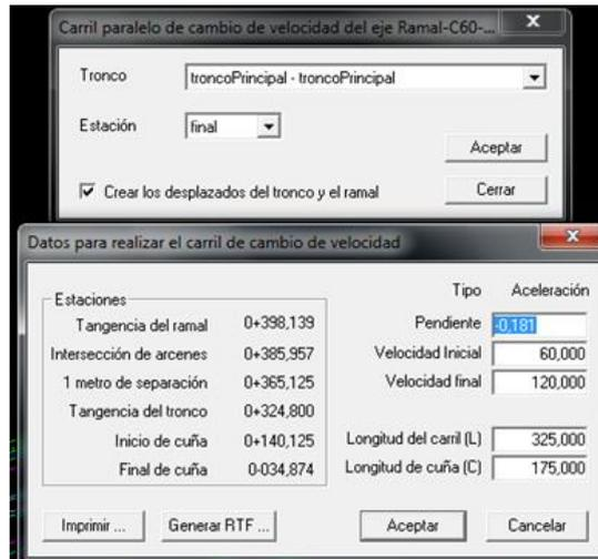
Figura 99: Generación del carril de aceleración (C60-AP7)
