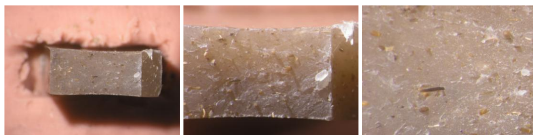
Figura IV.2.14. Imágenes de microscopía óptica a 8x, 16x y 25x para el compuesto BioPE/PO con un 5% de fibra de PO.
