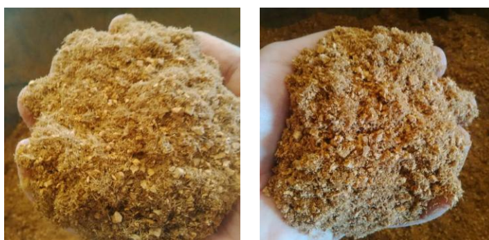
Figura IV.3.30. Aspecto de la mezcla de fibra de Posidonia oceanica , corcho triturado y resina de poliuretano.
