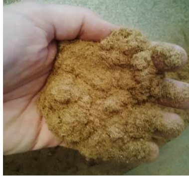
Figura IV.3.24. Aspecto de las fibras de posidonia oceanica trituradas empleadas para la fabricación del composite prototipo 1 (PUR/PO).
