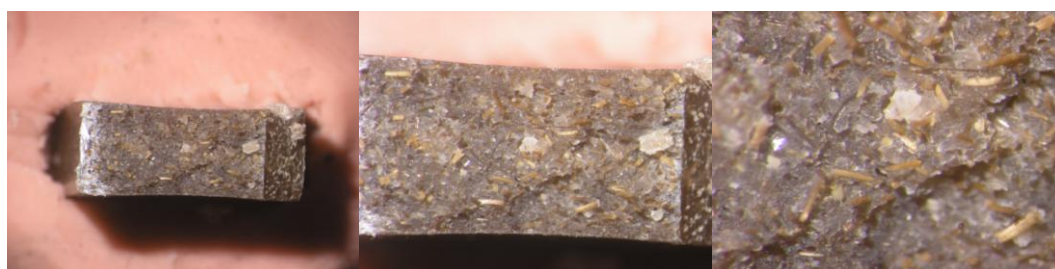
Figura IV.2.16. Imágenes de microscopía óptica a 8x, 16x y 25x para el compuesto BioPE/PO con un 20% de fibra de PO.
