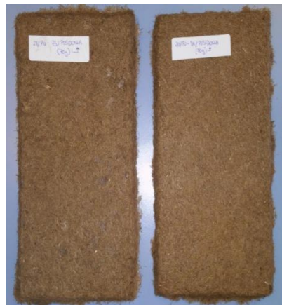
Figura III.2.5. Aspecto de los prototipos de compuestos BioPUR/PO en proporciones 20/80 (derecha) y 25/75 (izquierda).
