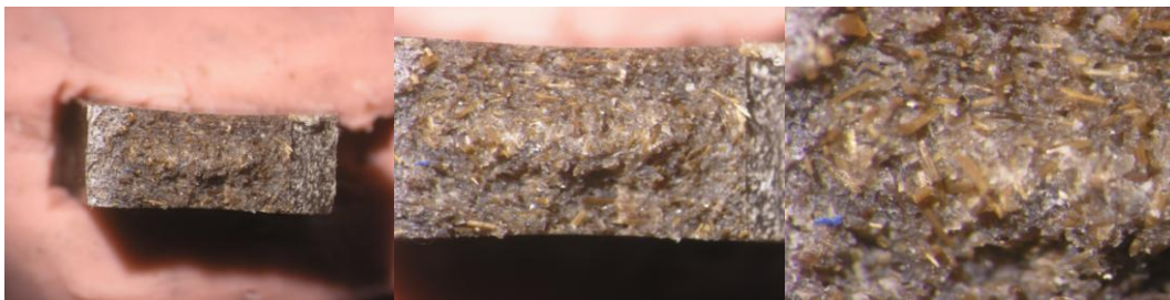
Figura IV.2.18. Imágenes de microscopía óptica a 8x, 16x y 25x para el compuesto BioPE/PO con un 40% de fibra de PO.
