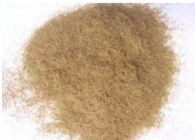
Figura III.1.2. Fotografía del aspecto macroscópico de la fibra corta de Posidonia oceanica después de proceso de lavado, trituración y secado.
