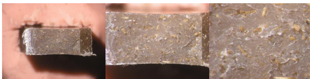
Figura IV.2.15. Imágenes de microscopía óptica a 8x, 16x y 25x para el compuesto BioPE/PO con un 10% de fibra de PO.
