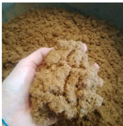
Figura IV.3.26. Aspecto de la mezcla de fibras de Posidonia oceanica trituradas con resina de poliuretano con resistencial al fuego (PUR-FR).
