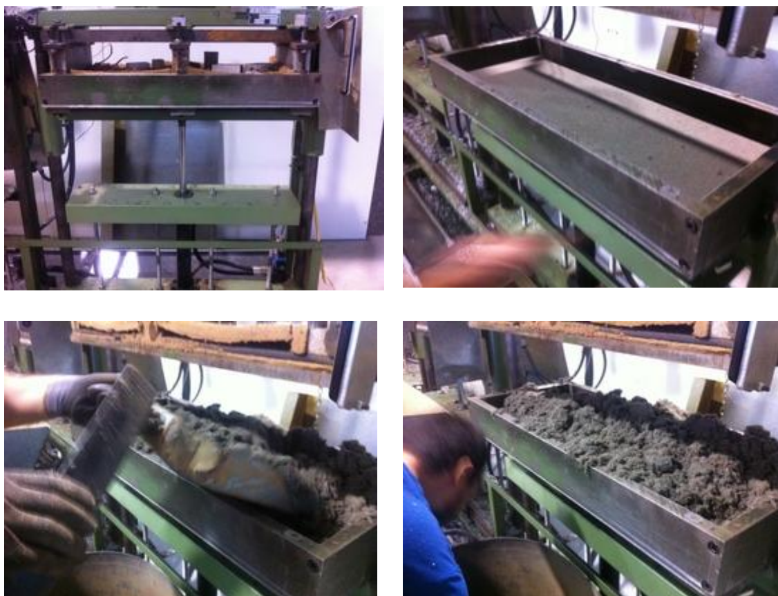
Figura IV.3.22. Diversas etapas en el proceso de llenado del molde de termocompresión de láminas con la mezcla de materiales.
