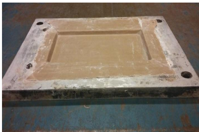
Figura III.2.3. Molde empleado en la fabricación de los biocomposites BioPUR/PO con acabado de teflón para facilitar la extracción de los compuestos.
