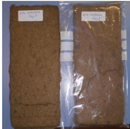
Figura III.2.4. Aspecto de los prototipos de compuestos BioPUR/PO en proporciones 10/90 (derecha/descartado) y 15/85 (izquierda).
