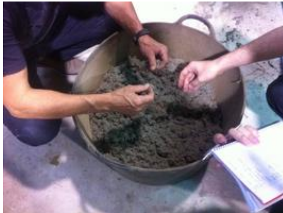
Figura IV.3.21. Muestra de la mezcla de las materias primas tras la incorporación de la resina de bioPUR.
