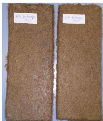
Figura III.2.6. Aspecto de los prototipos de compuestos BioPUR/PO en proporciones 30/70 (derecha) y 40/60 (izquierda).
