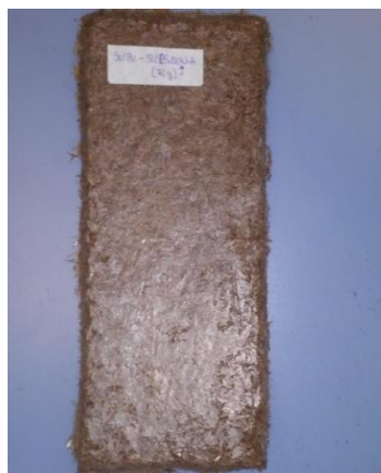
Figura III.2.7. Aspecto de los prototipos de compuestos BioPUR/PO en proporción 50/50.
