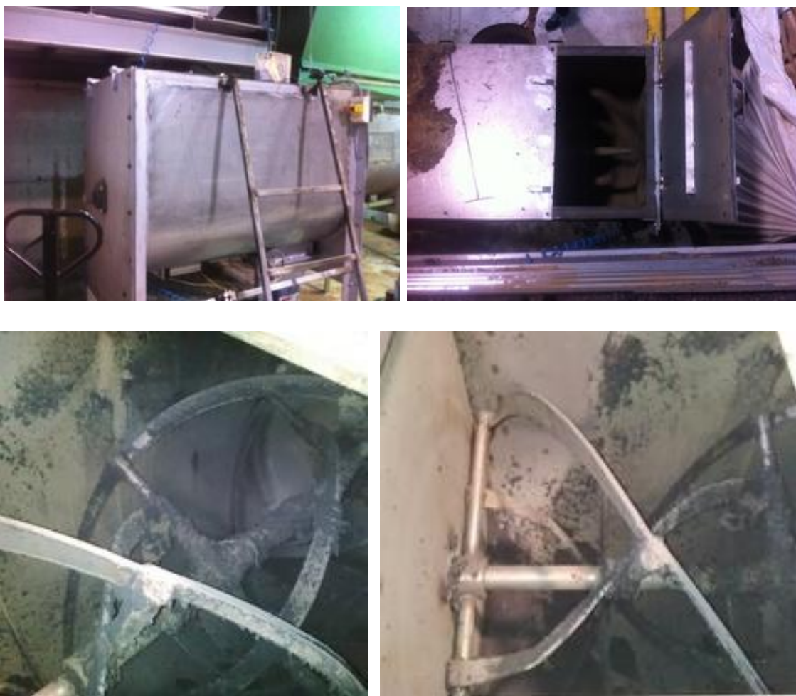
Figura IV.3.20. Diferentes imágenes de la mezcladora disponible en empresa, Esfyr para el mezclado de las materias primas.
