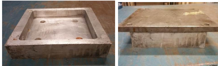
Figura III.2.8. Molde utilizado para hacer las planchas de posidonia para la caracterización térmica y acústica.
