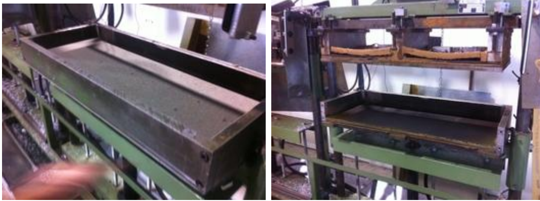
Figura IV.3.23. Imágenes de la apertura del molde y extracción de la lámina de material compuesto termoconformada.
