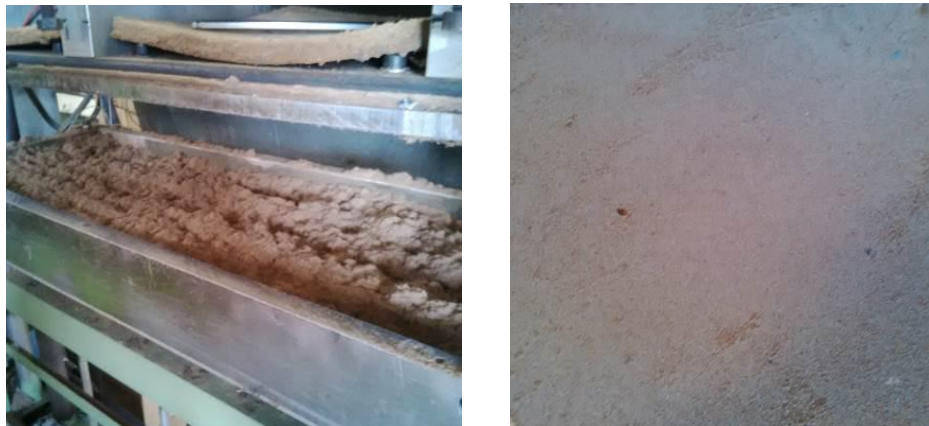
Figura IV.3.25. Llenado del molde de termocompresión con la mezcla de fibra de PO y resina de poliuretano (izquierda) y aspecto de la plancha de compuesto PUR/PO fabricada con fibra de PO y resina de biopoliuretano (derecha).
