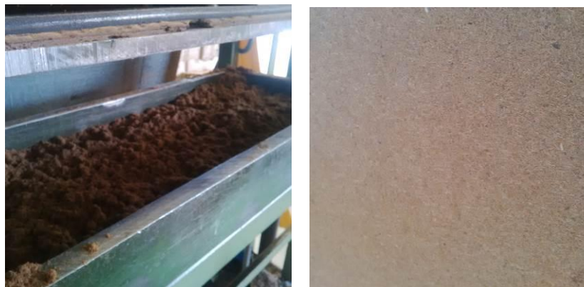
Figura IV.3.27. Llenado del molde de termocompresión con la mezcla (izquierda) y aspecto del panel compuesto PUR-FR/PO obtenida con fibra de Posidonia oceanica y resina de poliuretano FR (derecha).
