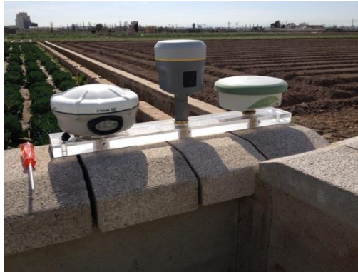
Figura 3.1. Antenas utilizadas en campo. Elaboración propia.
