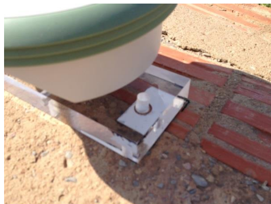
Figura 4.27. Marcado del punto de estacionamiento. Elaboración propia.
