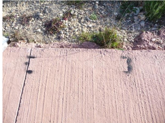
Figura 4.6. Marcado del punto de estacionamiento. Elaboración propia.
