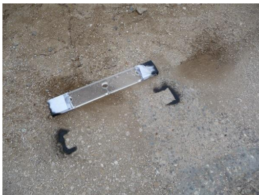
Figura 4.40. Marcado del punto de estacionamiento. Elaboración propia.
