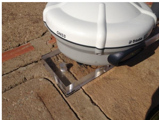
Figura 4.26. Marcado del punto de estacionamiento. Elaboración propia.
