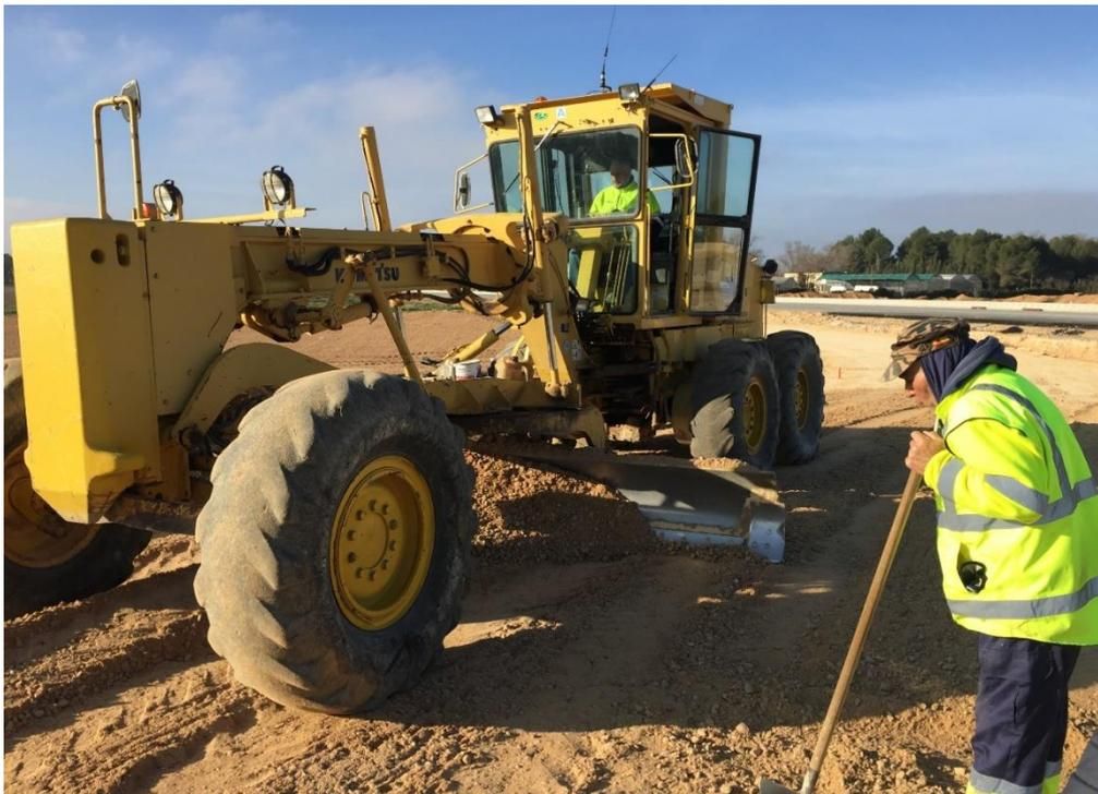
*Ilustración 31. Niveladora*
