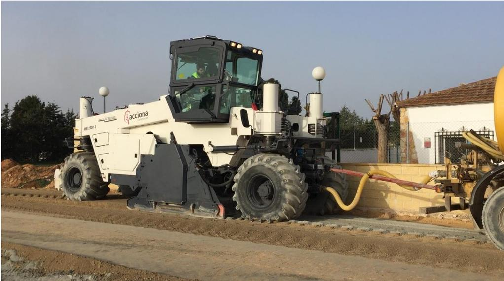
*Ilustración 33. Estabilizadora Wirtgen*
