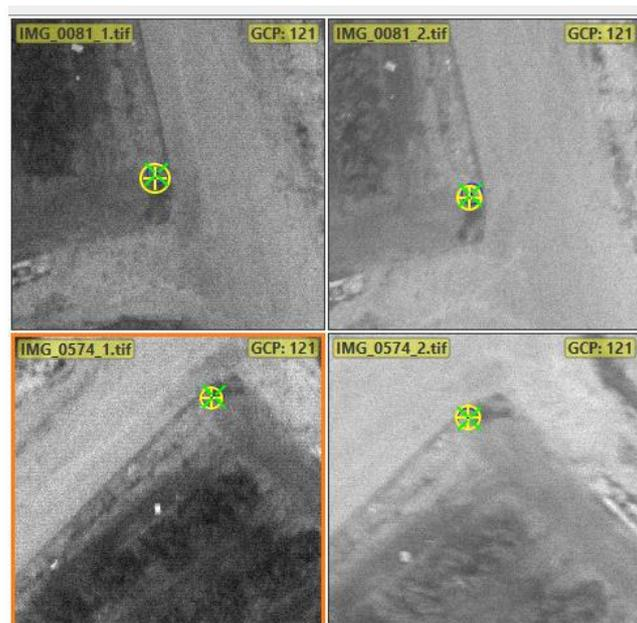
Figura 20: Geoposicionamiento de los puntos de control al terreno
