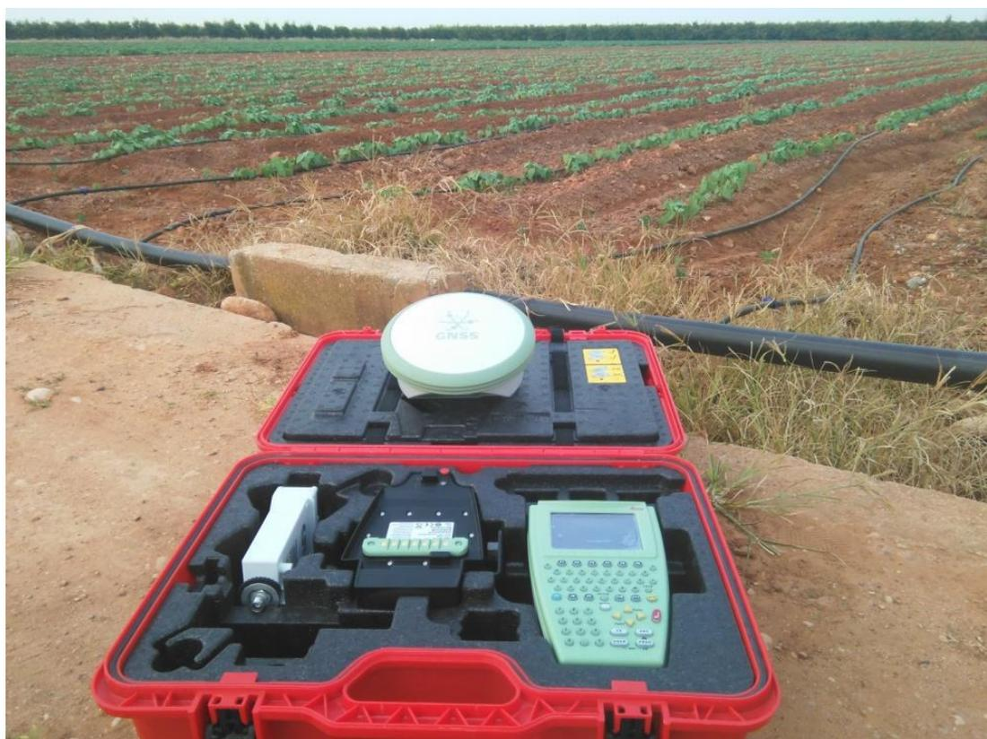
Imagen 9: Caja de herramientas del GPS LEICA
