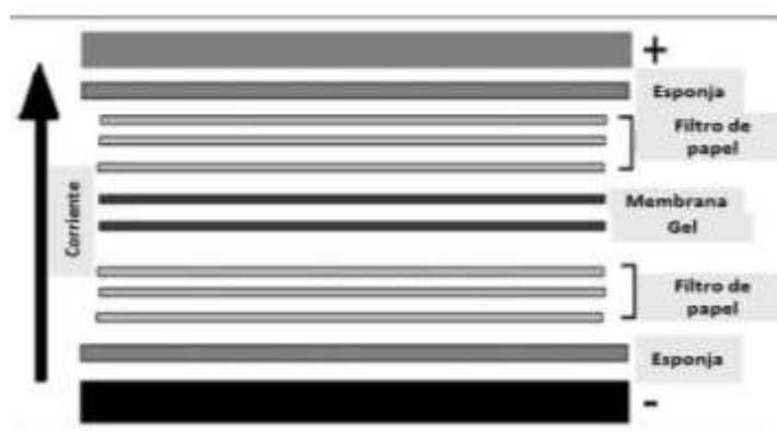
Figura 6. Esquema de las capas posicionadas para la transferencia del gel de electroforesis a la membrana de PVDF.
