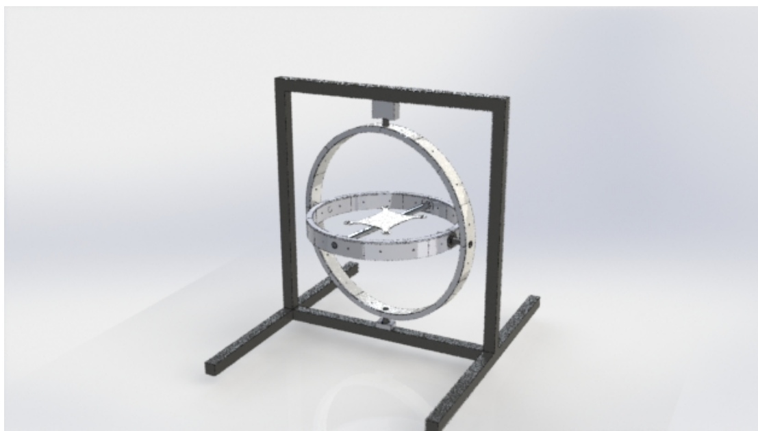
Figura 3.4: Base giroscópica de dos anillos impresa en 3D.
