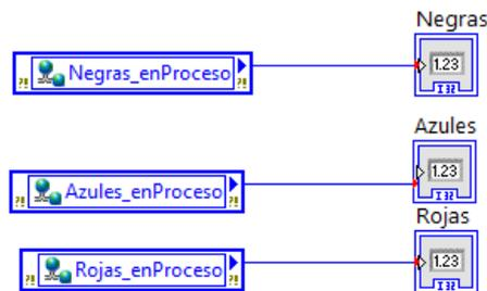
**Figura 93.** Asignación de las variables de piezas en proceso de mecanizado a indicadores.
