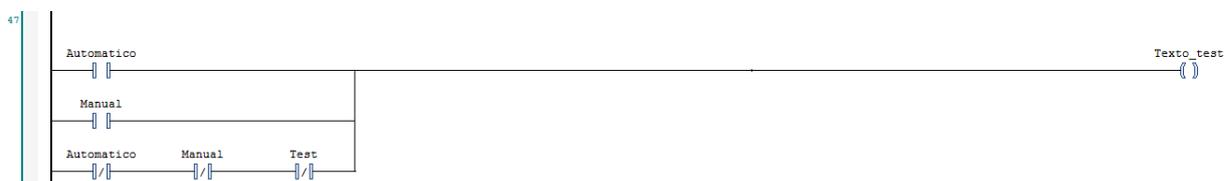
Figura 52. Diagrama de contacto de *Variables\_Visu\_proceso*. Conmutación entre visible e invisible del texto referente al modo test.
