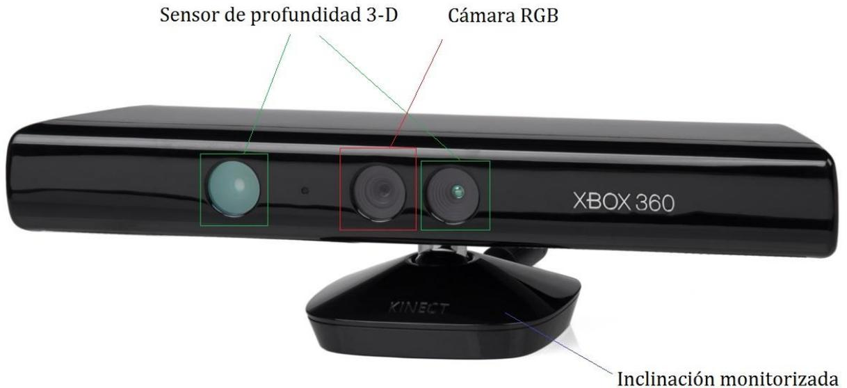
Figura 6. Sensor de visión *Kinect*.
