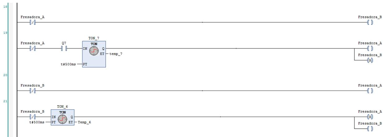
Figura 51. Diagrama de contactos de *Variables\_Visu\_proceso*. Conmutación entre los bordes de la fresadora (cuadrado y rectángulo rojo).
