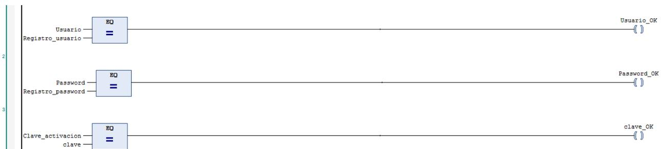
**Figura 42.** Verificación de los datos introducidos en pantalla con el registro previo. Diagrama de contactos de *Registrar*.
