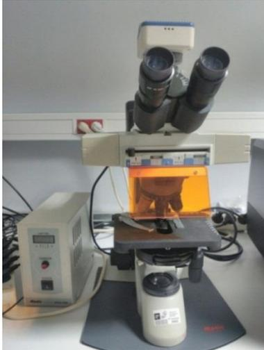
*Figura 9. Microscopio de fluorescència Motich BA400.*
