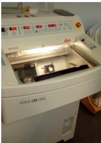
*Figura 6. Criostato Leica CM 1950, 50 Hz.*
