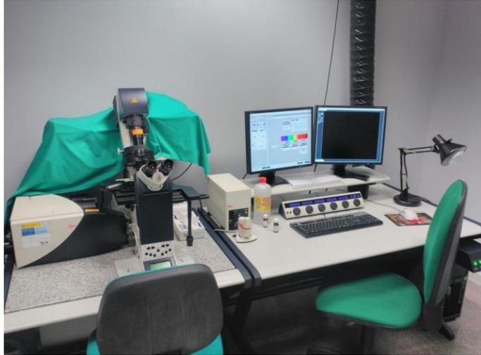
*Figura 10. Microscopio confocal Espectral Leica TCS-SP5.*
