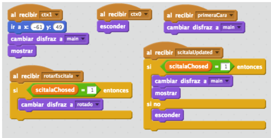
Figura 4.3: Fragmento de código asociado a la escitala espartana. Cuando el objeto reciba el mensaje «rotarEscitala», cambia el disfraz a otro con el fin de simular el movimiento de la rotación.
