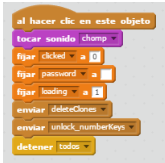
Figura 8.5: Fragmento de código asociado al objeto «Cancelar». Al pulsar sobre este objeto, el programa se para y el resto de los objetos vuelven a su estado inicial.
