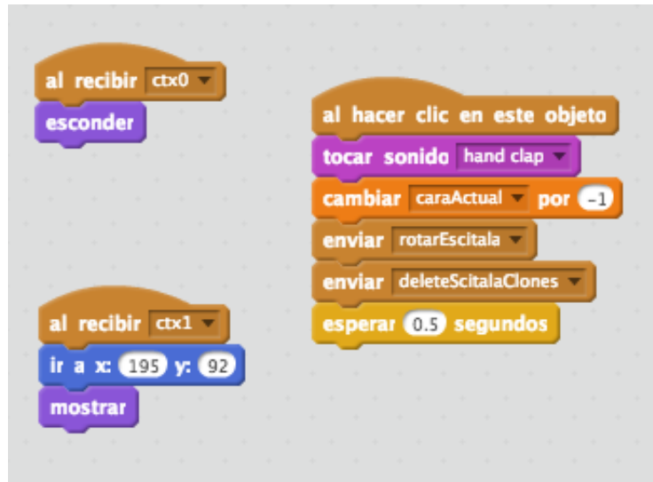
Figura 4.5: Fragmento de código asociado al botón de rotar la escítala. Tiene como objetivo sumar o restar la variable «caraActual».
