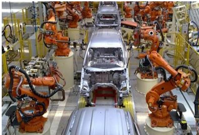
**Robots ABB en una cadena de producción de automóviles**
