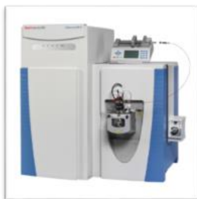
Figura 7. Imagen del espectrómetro de masas empleado en el ensayo: Q Exactive™ HF Hybrid Quadrupole-Orbitrap MS, de Thermo Scientific (Waltham, MA).
