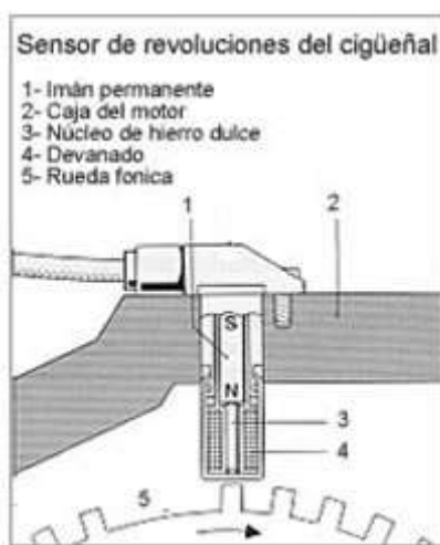
Fig. 4. Sensor de rotación también conocido como sensor de revoluciones o r.p.m.
