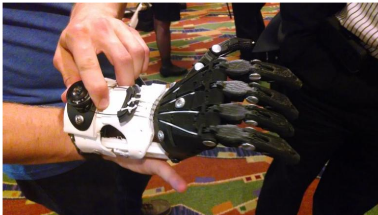
Ilustración 1: Prótesis de una mano realizada con una impresora 3D
