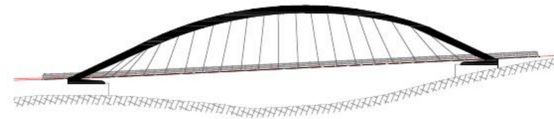
Figura 6. Alzado puente arco de tablero inferior
