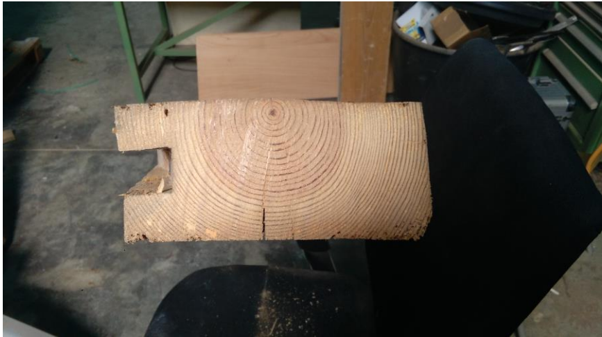
Figura 1.8. Corte transversal de un elemento de madera donde se puede distinguir la albura y el duramen. 2017. Fuente propia.
