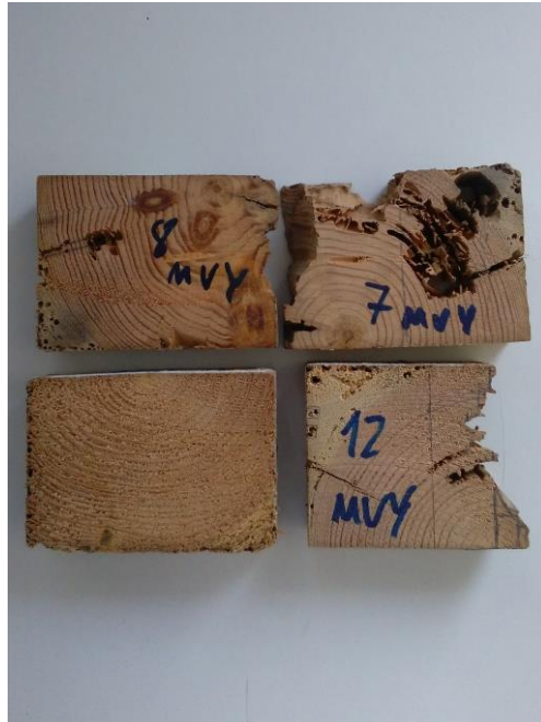
Figura 5.1. Muestras de densidad con distintos niveles de degradación procedentes de la inspección realizada en la C/Reina (Valencia). 2017. Fuente propia.
