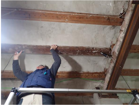
Figura AII.4. Colocando los transductores para la medición por ultrasonidos de una vigueta del forjado de planta 1 del edificio de Av. Corts Valencianes nº37. 2017. Fuente propia.
