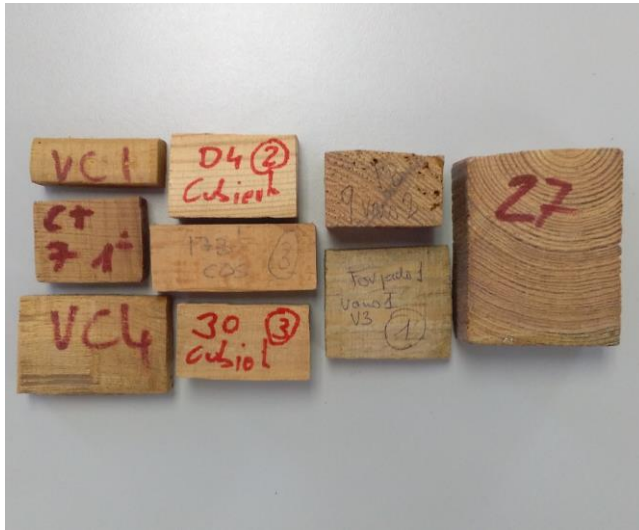
Figura 3.23. Algunas muestras de densidad de las inspecciones realizadas. 2017. Fuente propia.
