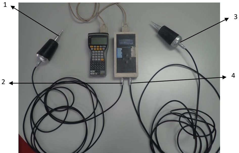
Figura 3.12. Equipo Sylvatest TRIO. 1; transductor emisor, 2; conector de transmisión ultrasónica, 3; transductor receptor, 4; conector de recepción ultrasónica. 2017. Fuente propia.
