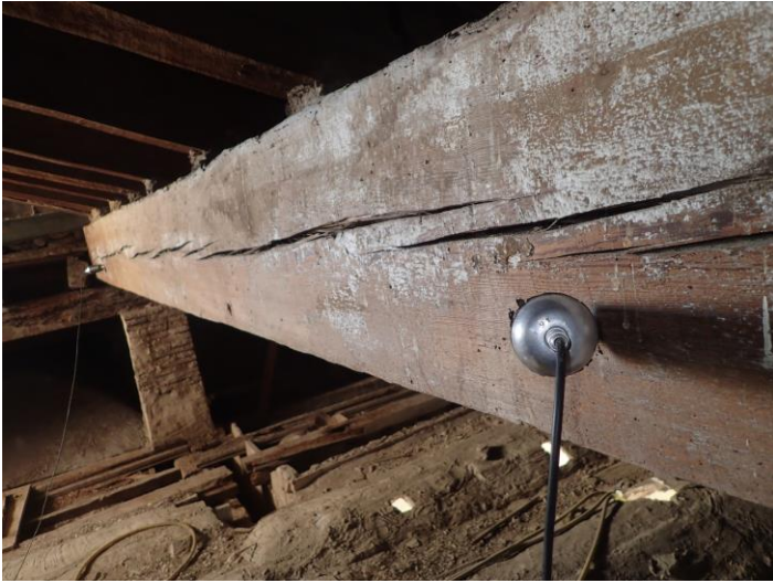
Figura 3.14. Medida de ultrasonidos según el método indirecto. 2017. Fuente propia.
