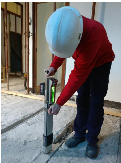
Figura 3.19. Ensayo de resistografía. 2017. Fuente propia.
