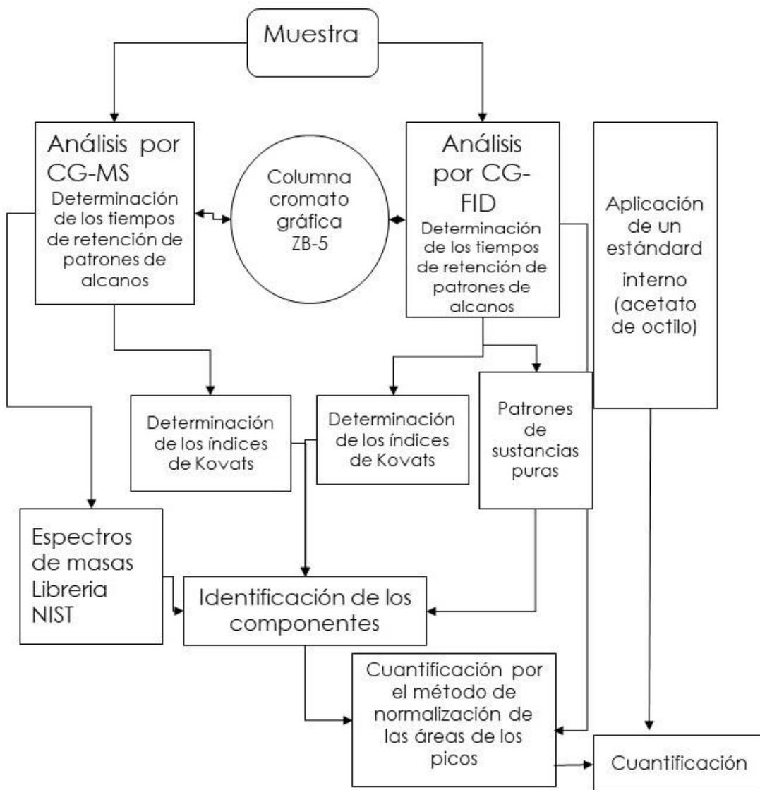
Ilustración 7 Esquema del método analítico
