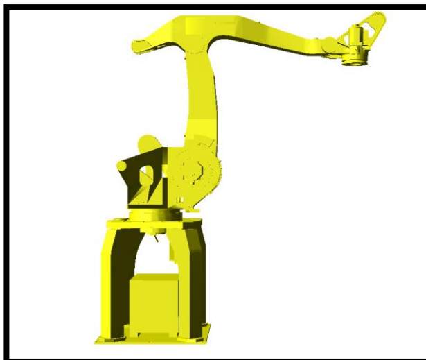
Figura 14. Eslabones que se tendrán en cuenta para la aplicación del algoritmo de Denavit-Hartenberg.
