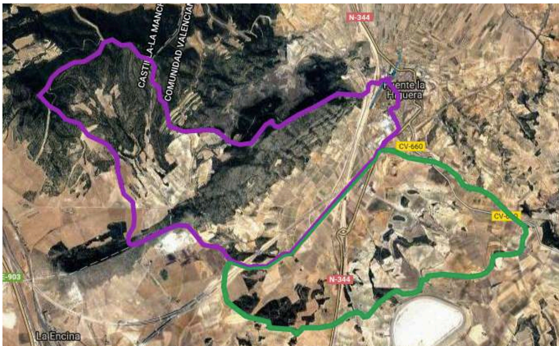
Fig. 8 - Cuenca del barranco dels Molins (morado) y cuenca vertiente en la trinchera del ferrocarril (verde) tras las obras de la autovía A-37 y la línea de alta velocidad Valencia - La Encina. FUENTE: Elaboración propia a través de Google Maps.
