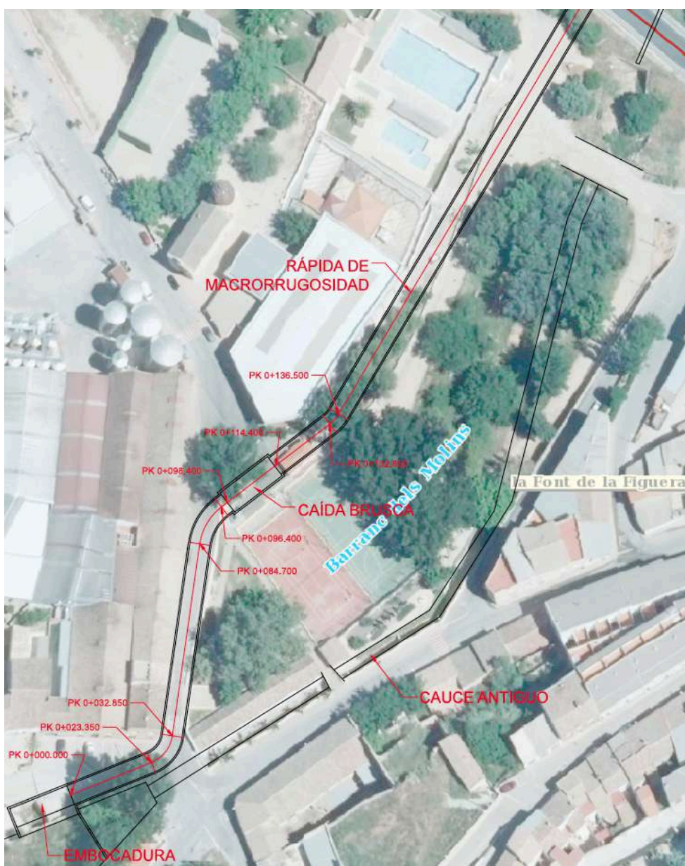
Fig. 21 - Zona urbana del tramo 1. FUENTE: Elaboración propia.
