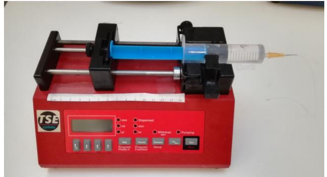
fig. 50. Bomba de jeringa utilizada. Se aprecia también la aguja acoplada y parte del tubo de plástico. Elaboración propia.
