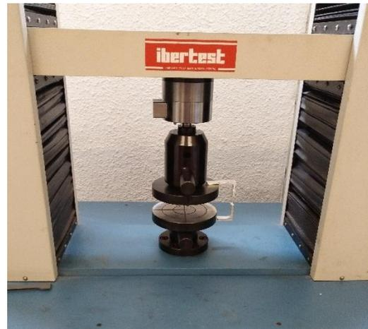
**Fig.26.** Fijación de los soportes para la colocación del extensómetro.
