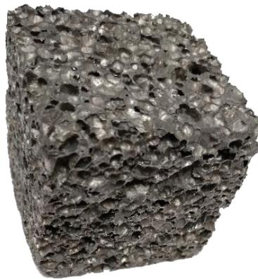
**Fig. 10.** Espuma de aluminio de poros cerrados
