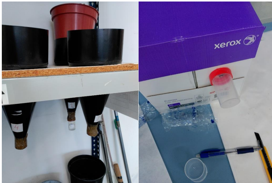
Figura 5 (izquierda); Figura 6 (derecha). A la izquierda se puede observar, al fondo, el embudo de Berlese completamente montado. A la derecha se contempla la caja ya cerrada con el material vegetal en su interior, se puede apreciar el bote colocado y el agujero practicado en la superficie de la caja.
