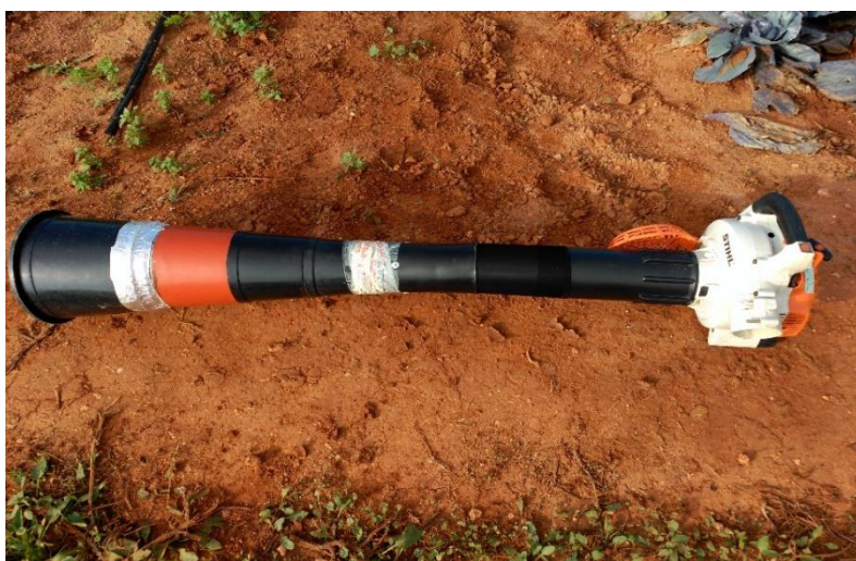
Figura 4. Aspirador preparado para realizar el muestreo en campo, se puede observar el canalón del aspirador con la malla entomológica ya colocada y el accesorio acoplado.
