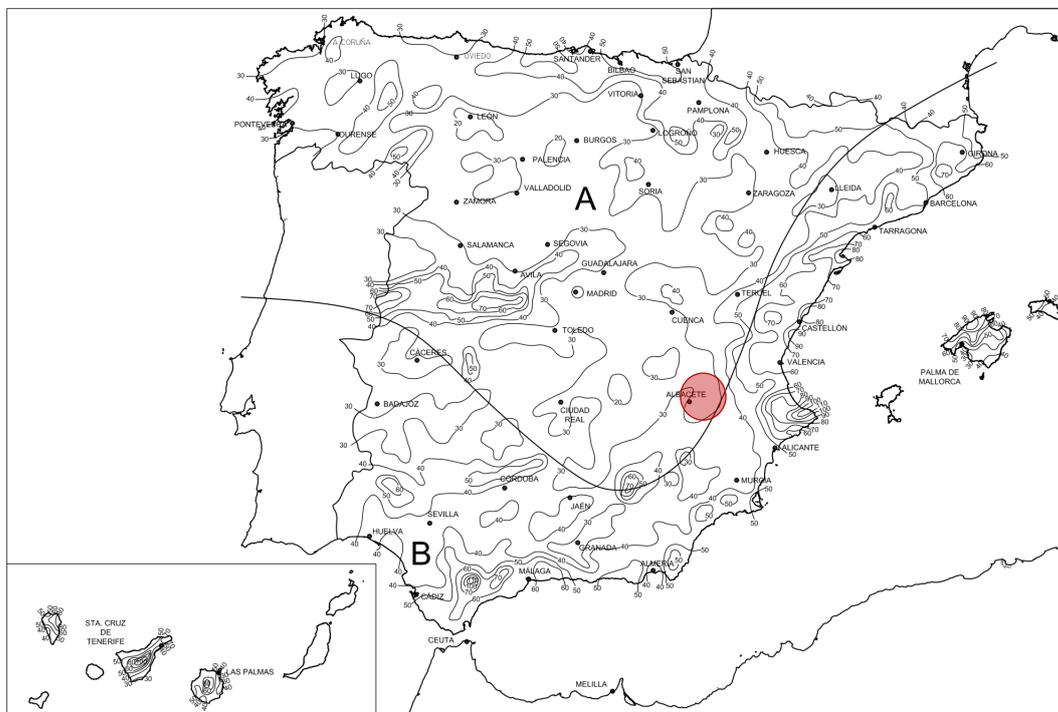
Ilustración 1: Isoyetas, zonas pluviométricas de España y localización del proyecto. Fuente: CTE DB HS 5
