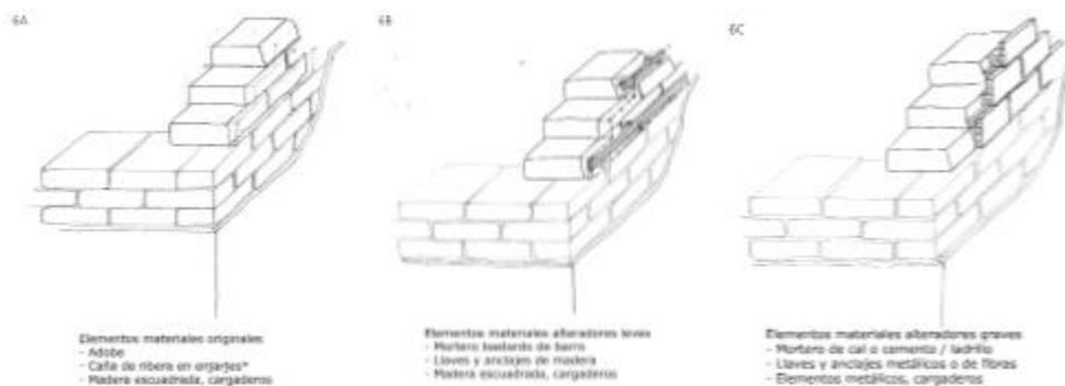
Ilustración 158: Degradación del muro por erosión. Fuente: Juan Antonio García Esparza.
