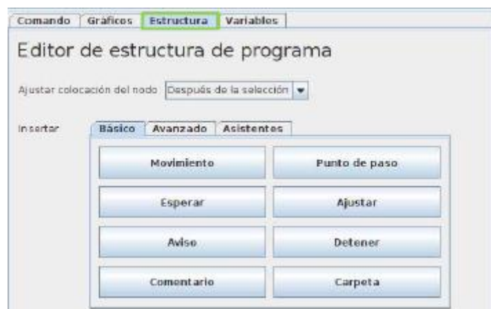
Ilustración 29 Ventana estructura del UR3.
