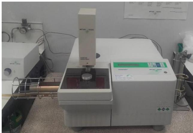
**Figura 28** Termogravímetro utilizado durante el proyecto.
