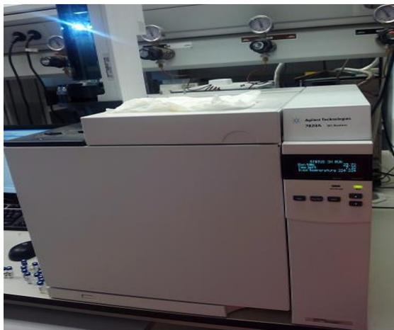
**Figura 30** Cromatógrafo de gases usado en el proyecto.
