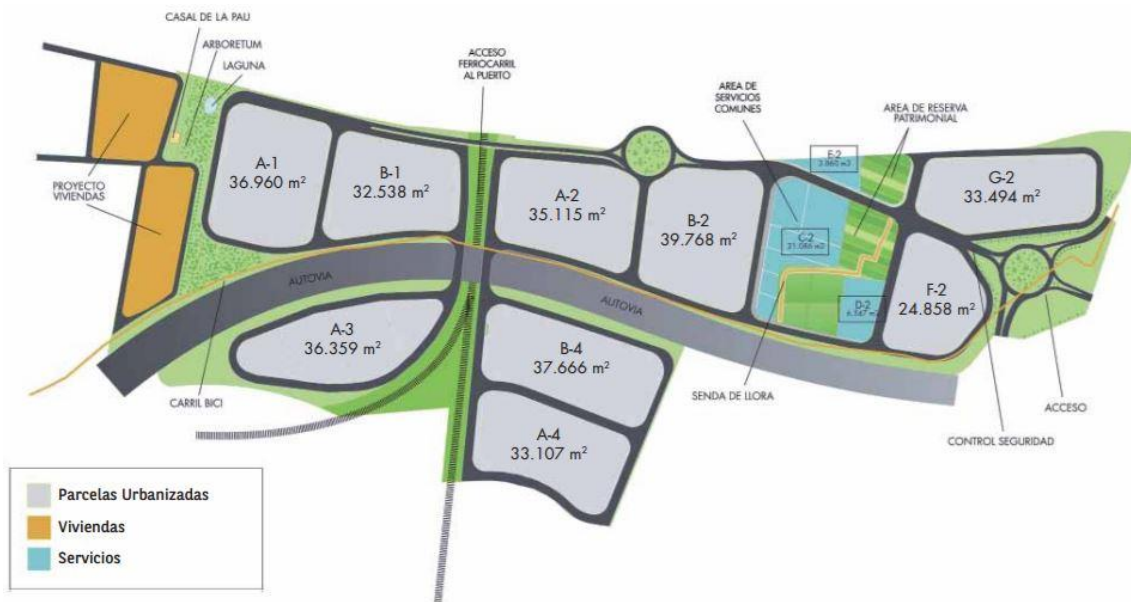
Ilustración 25 Esquema de las parcelas y usos de la ZAL del puerto de València. Fuente: Valenciaport
