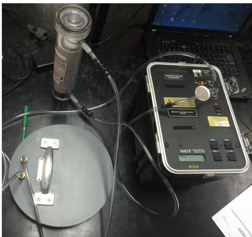
**Figura 36. Circuito de purga para la cámara de emisión superficial**
