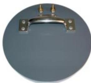
Figura 34. Cámara superficial de exhalación radón (Emission Chambers User Manual, 2012)
