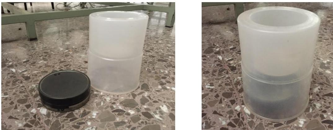
Figura 43. Cánister de carbón activo y recipiente impermeable al radón
