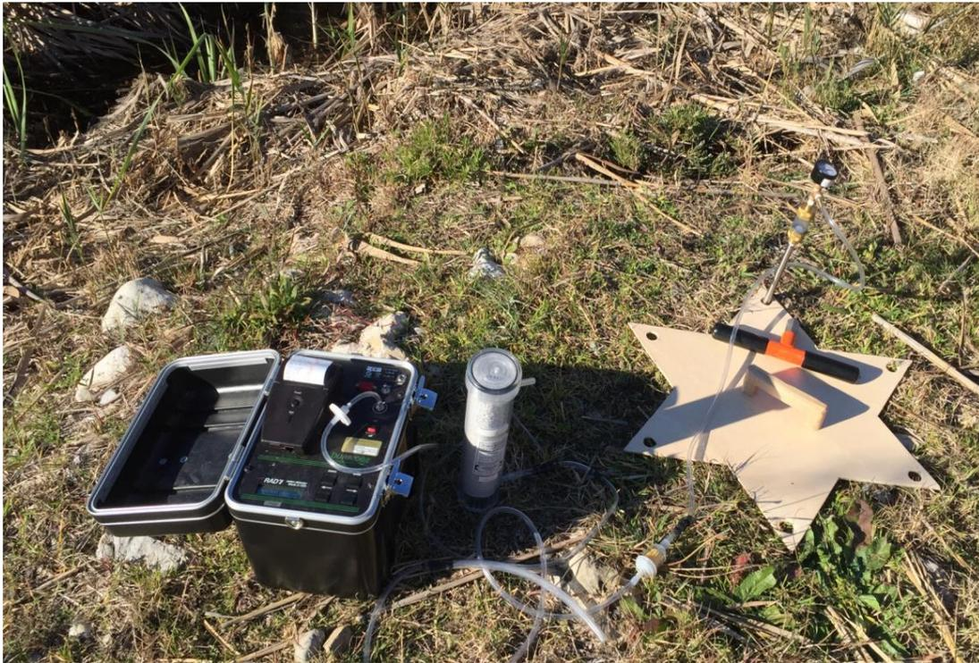
**Figura 33. Configuración para la medición de exhalación de radón mediante la sonda de gas**
