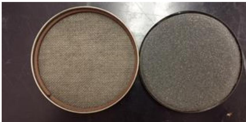
**Figura 44. Cánister de carbón activo expuesto al aire**
