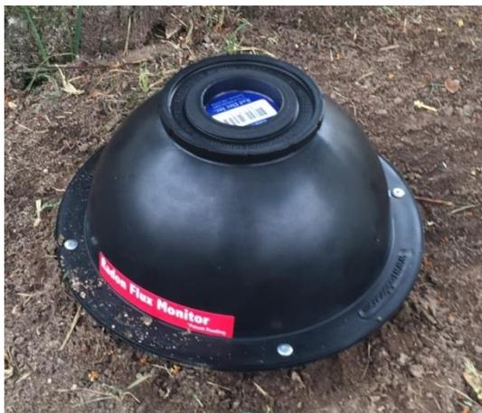
Figura 38. Cámara H conectada al electrete
