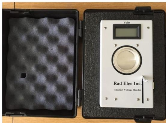
Figura 40. Medidor de voltaje SPER-1 Voltage Reader
