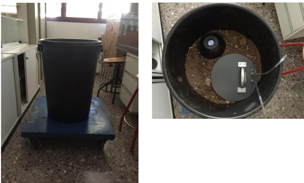
**Figura 24. Ubicación del depósito para la medición de concentraciones medias de radón**
