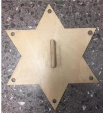
**Figura 32. Dispositivo creado para la medición de radón emanado mediante la sonda de gas de suelo**
