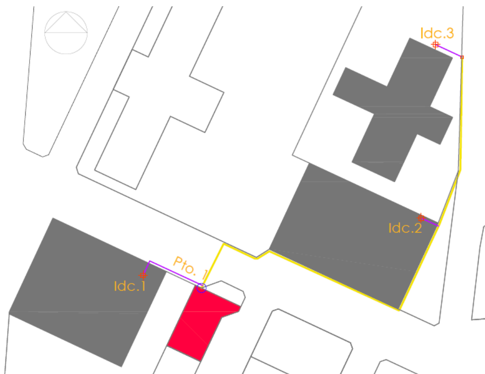
Fig. 4. Trazado del circuito de distribución de calor. Fuente: Elaboración propia.
