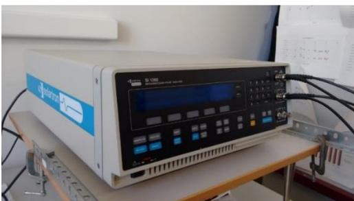
Figura 4.3. Analizador de impedancia Solartron SI 1260.
