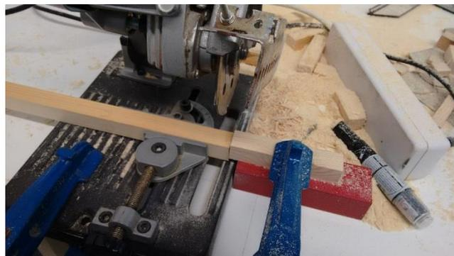
Figura 2.2. Detalle de la sierra radial en el corte de piezas de 2x2x1cm. En la parte derecha se aprecia la referencia límite para conseguir piezas de 1 cm de grosor.
