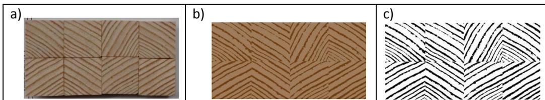
Figura 4.16. Distintos estados del procesado de imagen para la obtención del porcentaje de madera tardía, mediante conjuntos de ocho piezas. a) Fotografía original previa a la edición; b) Imagen indexado a dos colores; c) Imagen en formato binario.
