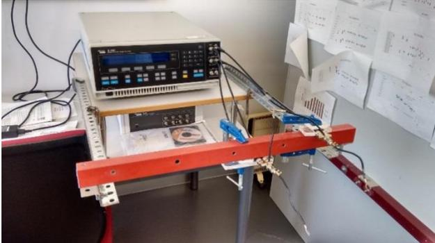
Figura 4.4. Analizador Solartron SI 1260 y estructura de soporte para el cableado.
